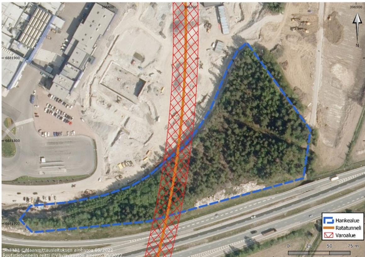
Kuva 6-37. Hankealueen alapuolella kulkee Vuosaaren rautatietunneli, jonka varoalue ja käyttöoikeusraja tulee huomioida louhinnan suunnittelussa.
