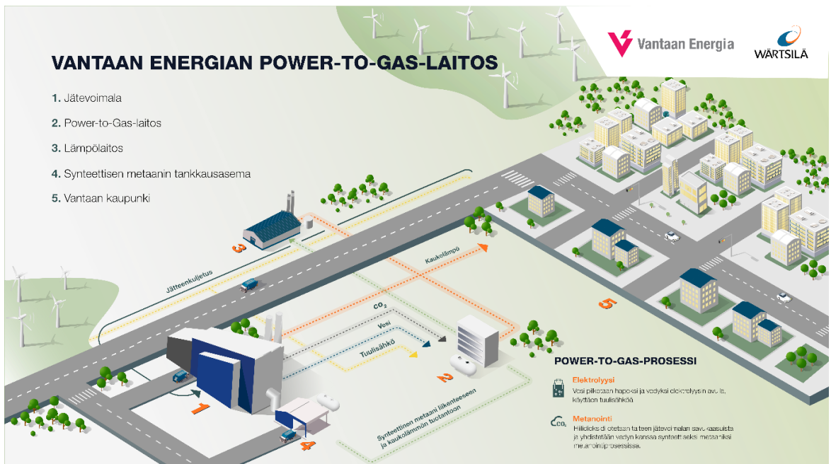
Kuva 3-2. Vantaan Energian sähkölaitteainelaitoksen prosessien liittyminen jätevoimalan toimintoihin. (Lähde: Vantaan Energia Oy)
