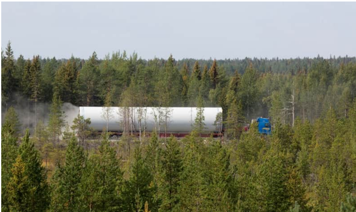
Kuva 4.15 Tuulivoimalan torniosien kuljetusta (FCG Finnish Consulting Group Oy).
