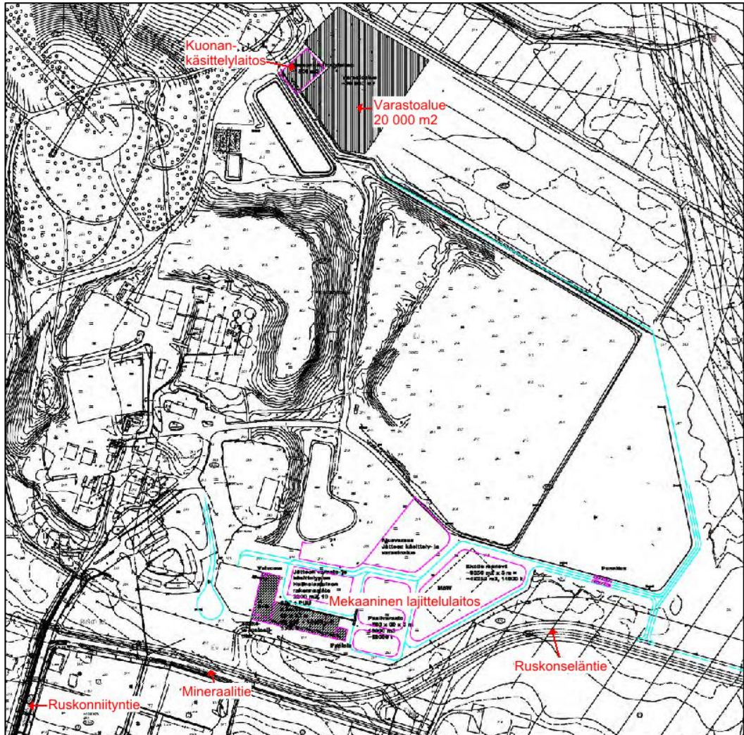
Kuva 8. Alustava asemapiirros jätteen kuonankäsittelyn ja mekaanisen lajittelun laitospakennuksen ja varastoalueiden (hankevaihtoehdot VE1 ja VE2) sijoittumisesta Ruskon jätekeskuksessa. Sinisellä on merkitty jätekeskuksen alueelle rakennettavat uudet tiet.
