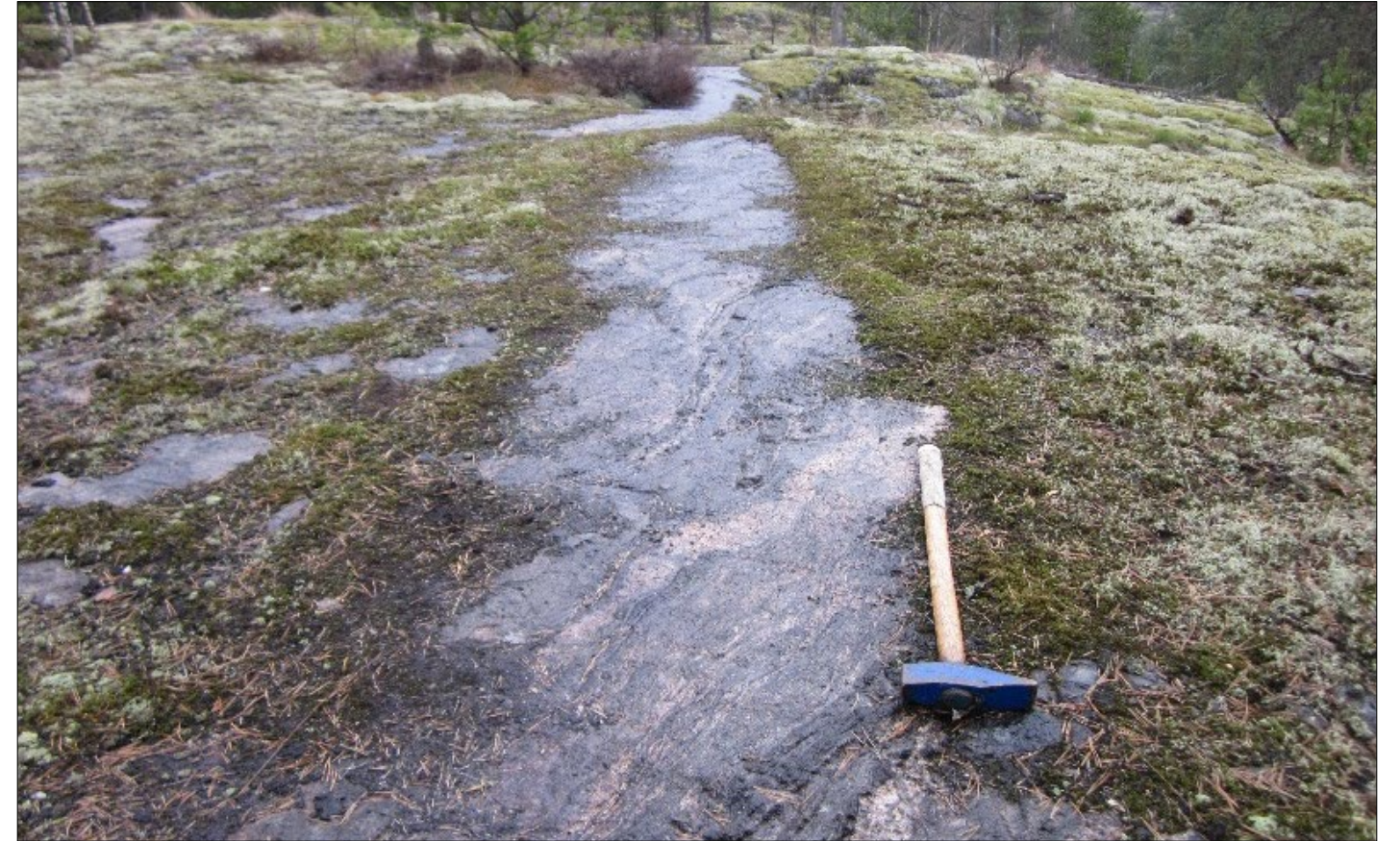
Kuva 7.14. Kalliopaljastuman pinnalla graniitti ja gneissi esiintyvät migmatiitissa mutkittlevina raitoina. Kallio on kohouma-alueilla pääosin harvarakoista. Kuva Hältingbergetin laelta, jossa on kulunut polkuverkosto.
