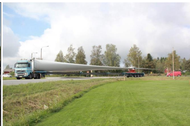
Kuva 4.9. (Vasemmalla) Esimerkki tuulivoimapuiston rakennus- ja huoltotiestä. Teitä käytetään muun muassa betonin, soran ja voimaloiden komponenttien kuljetuksiin sekä tuulivoimapuiston käyttövaiheessa huoltoajoihin. Maakaapeli sijoitetaan ojakaivantoon tien reuna-alueelle (Kuva: Ville Suorsa / FCG).
