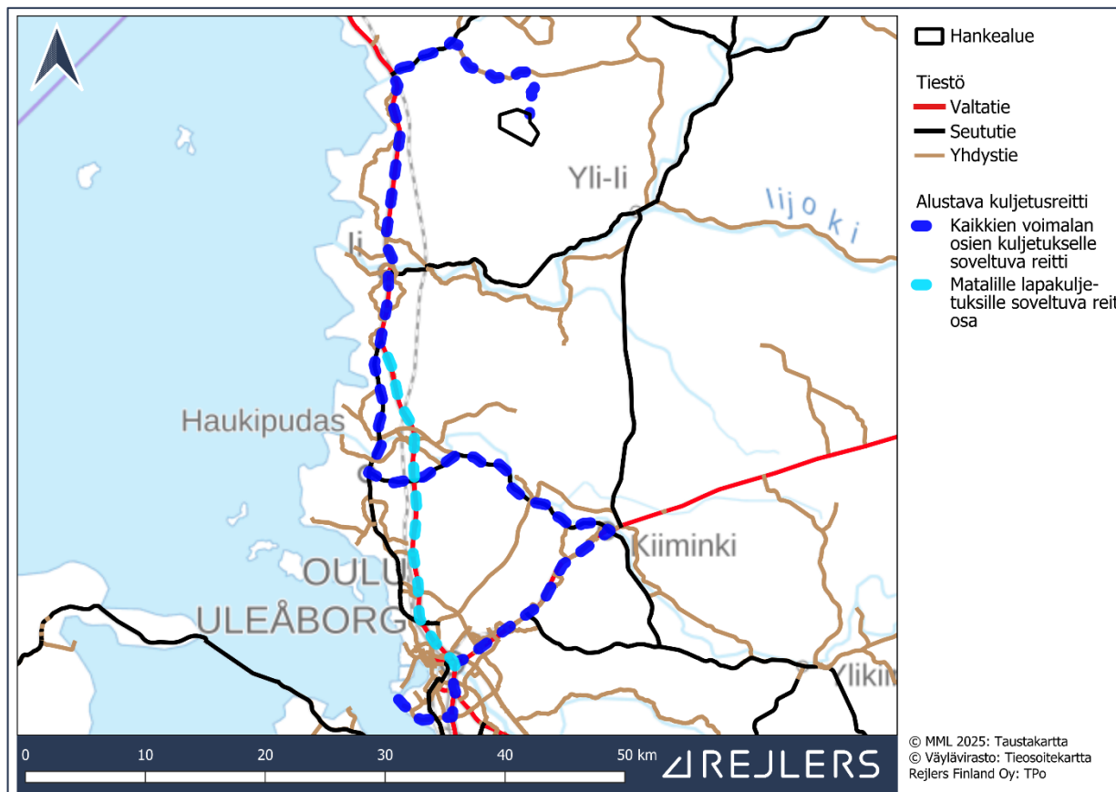
Kuva 36. Tuulivoimaloiden osien suunniteltu kuljetusreitti Oulun satamasta hankealueelle.
