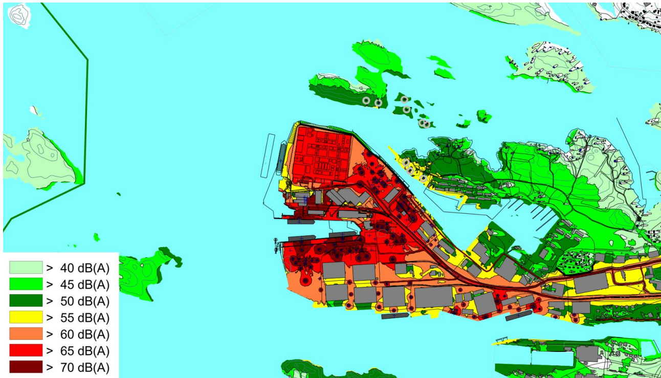
Kuva 4-51. Rauman sataman ja hankevaihtoehdon VE1 toiminnan aikainen yhteismelumallinnus. Päiväajan keskiäänitasot. (liite 6)
