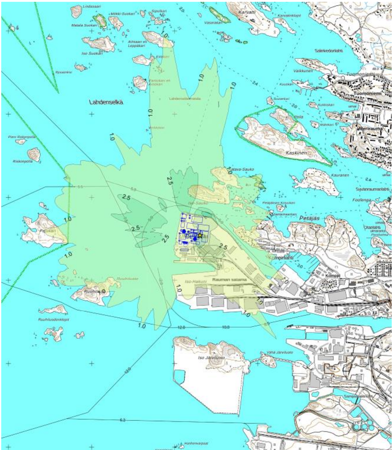
Kuva 4-34. Typpidioksidin ( \text{NO}_2 ) pitoisuuksien leviäminen vaihtoehdossa VE2. Korkein vuorokausi-ohjearvoon verrannollinen pitoisuus ( 70 \mu\text{g}/\text{m}^3 ) ei ylitä koko tarkastelualueella. Maksimipitoisuuden ( 10,0 \mu\text{g}/\text{m}^3 ) sijainti on esitetty kuvassa keltaisella tähdellä.
