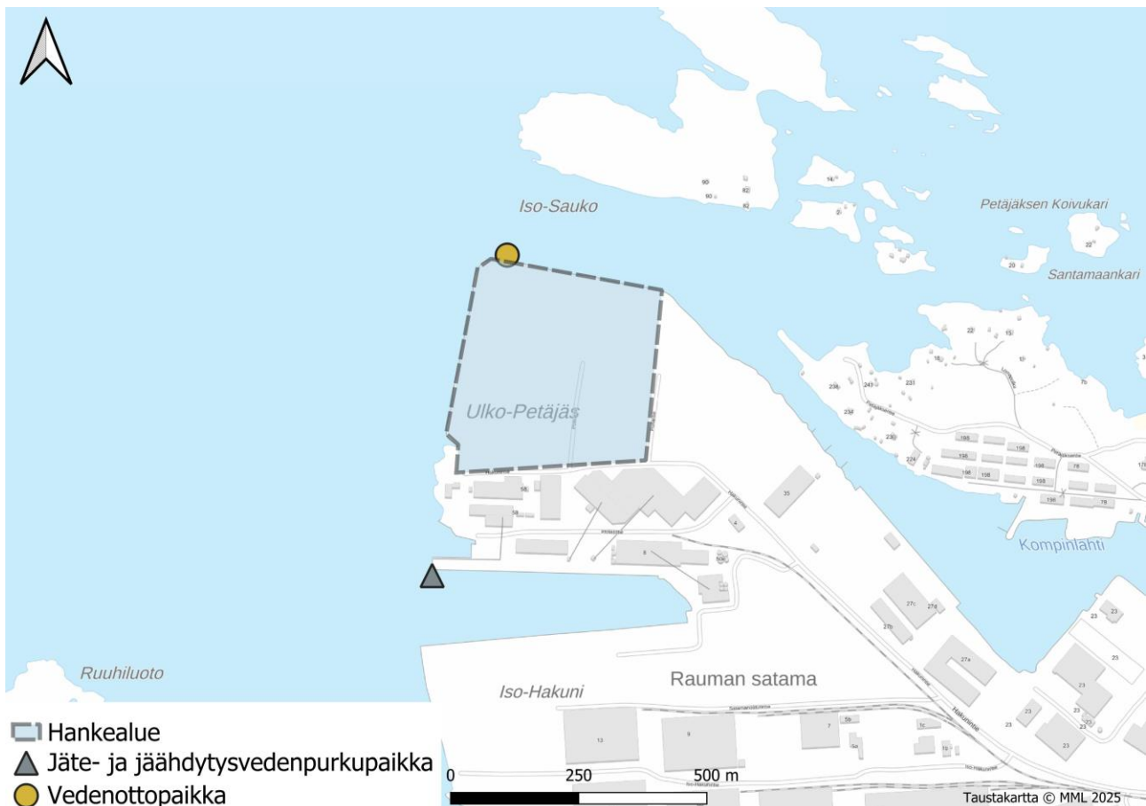
Kuva 4-5. Hankkeessa käytettävät vedenottopiste sekä puhdistettujen jätevesien ja jäähdytysveden purkupaikka.
