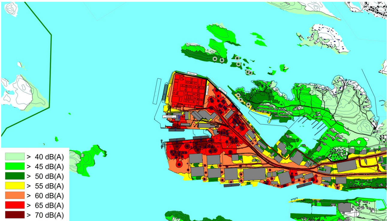
Kuva 4-53. Rauman sataman ja hankevaihtoehdon VE1 toiminnan aikainen yhteismelumallinnus. Suunniteltu meluntorjunta. Päiväajan keskiäänitasot. (liite 6)
