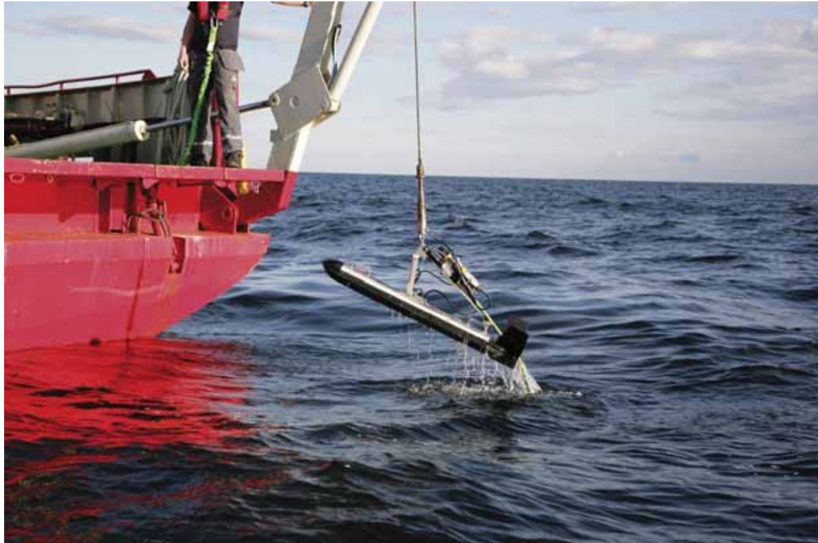
Kuva 4-5. Viistokaikuluotainta (SSS) käytetään geofysikaalisissa tutkimuksissa. Kuva: Nord Stream AG.
