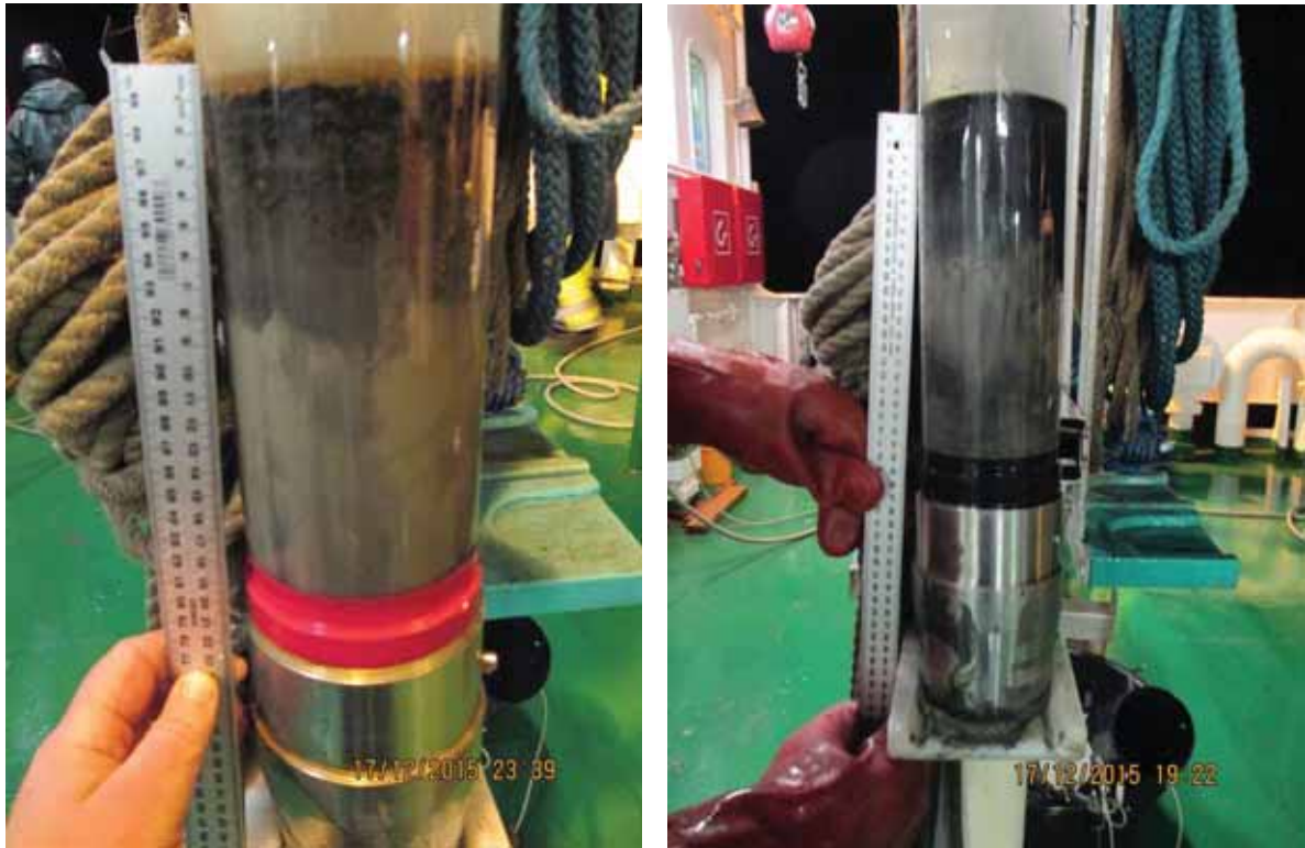
Kuva 7-5. Sedimenttiprofiilit alueellisella asemalla FIN_EBS_LUO_2 (kuva 7-7). Rikkivedyn hajua havaittiin oikeanpuoleisen kuvan profiilissa. Vesisyvyys oli 69 m (vasen kuva) ja 74 m (oikea kuva).
