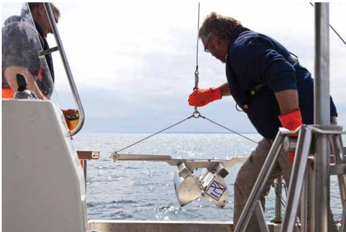
Kuva 4-21. Pohjaelännäytteenotossa käytetty Van Veen -näytteenottolaite. Kuva: Nord Stream AG.
