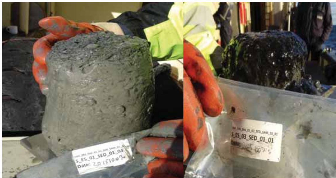
Kuva 9-11. Pintasedimentin laatu tutkimuskäytävän pohjoisosassa Ruotsin vesialueella lokakuussa 2015 tehdyn ympäristön nykytilan tutkimuksen aikana (vasen kuva: syvyys 168 metriä, ja oikea kuva: syvyys 205 metriä; DHI 2016b).
