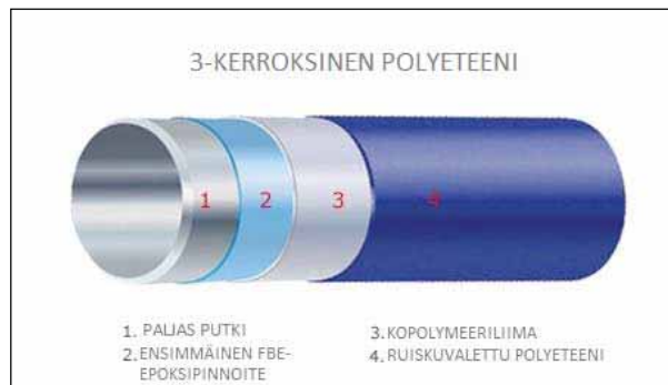
Kuva 4-3. Kolmikerroksinen korroosionestopinnoite.
