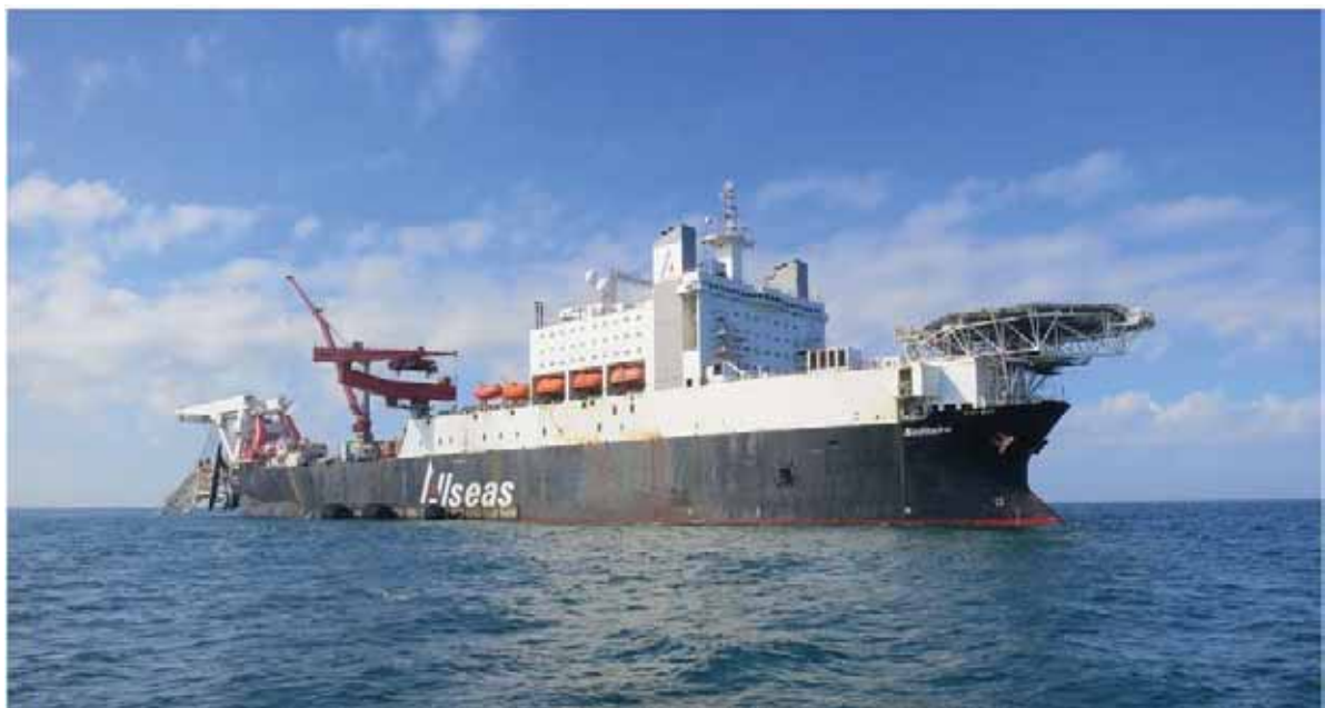
Kuva 4-13. Tyypillinen DP-alus – Allseas Solitaire. Kuva: Nord Stream AG.
