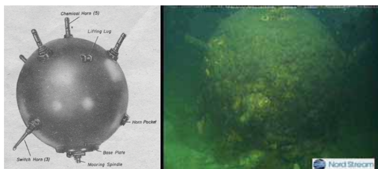
Kuva 7-56. Saksalainen UMA ankkuroitu kosketusmiina, jonka räjähdysaineen paino oli 30 kg, kehitettiin vuonna 1928. Nord Stream -hankkeen aikana raivattiin kaikkiaan 12 tämän tyyppistä miinaa (Witteveen+Bos 2011).
