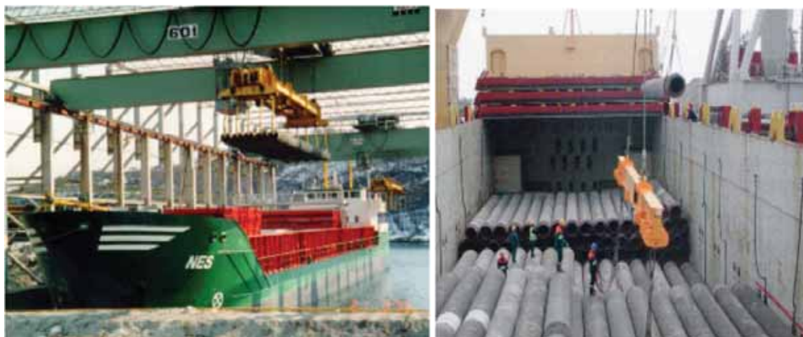
Kuva 4-15. Pinnoitettujen putkien lastaaminen kuljetusalukseen. Kuva: Nord Stream AG.
