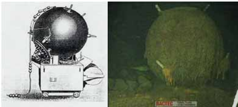
Kuva 7-58. Venäläinen kelluva kosketusmiina tyyppi M-08/39, jonka räjähdysaineen paino oli 115 kg, kehitettiin vuonna 1908, ja se oli tärkein venäläinen ensimmäisessä maailmansodassa käytetty miina. Nord Stream -hankkeen aikana raivattiin kaikkiaan 5 tämäntyyppistä miinaa (Witteveen+Bos 2011).
