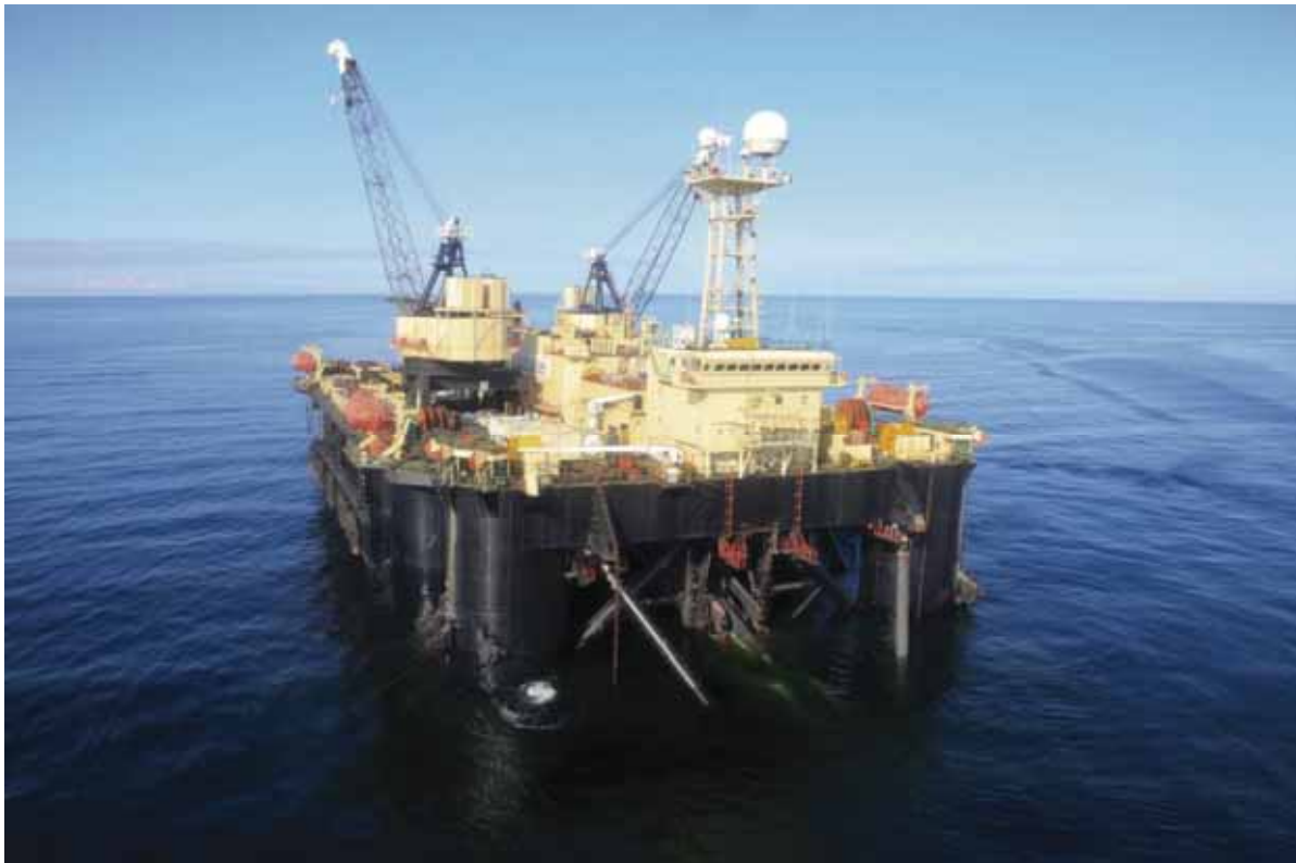
Kuva 4-12. Ankkuroitava putkenlaskualus – Castoro Sei. Kuva: Nord Stream AG.
