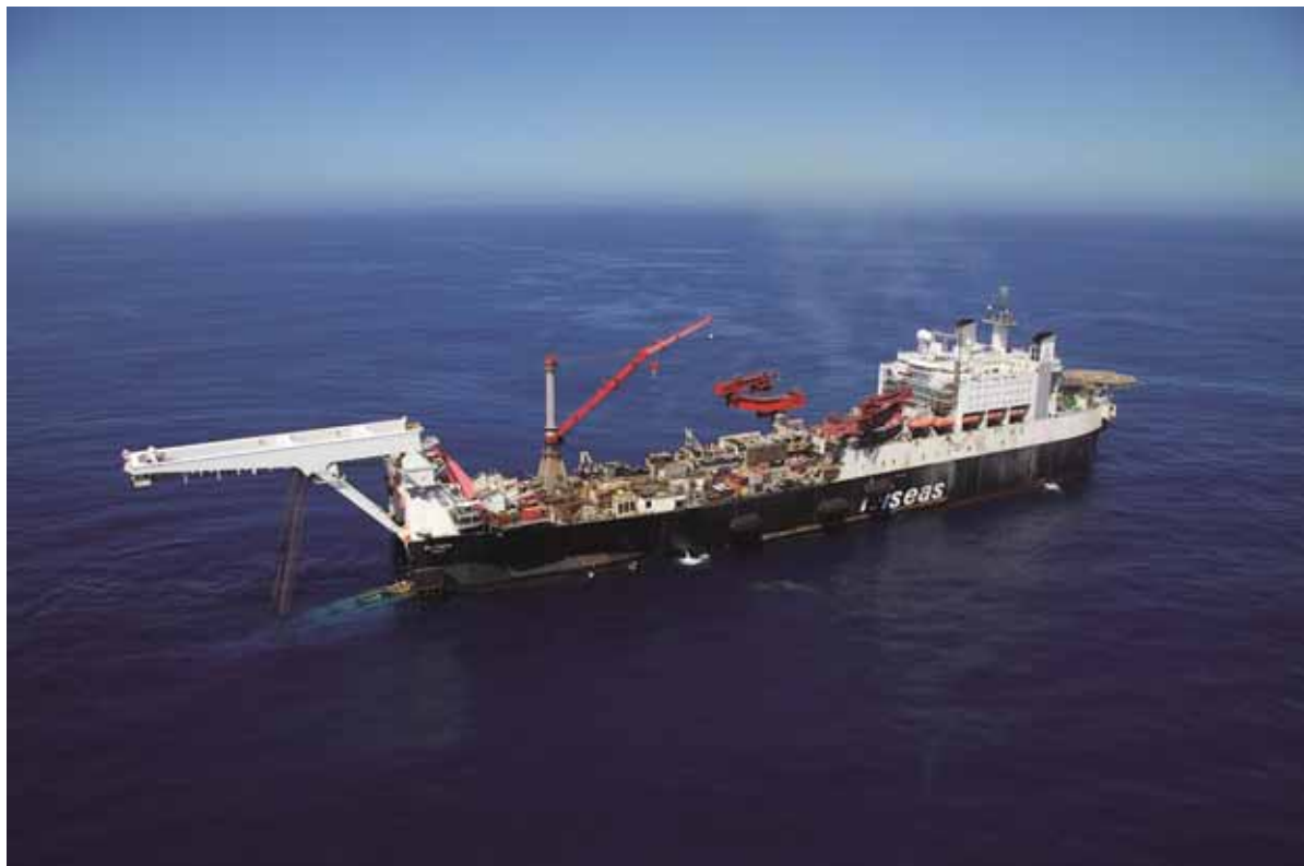
Kuva 4-10. S-asennukseen käytettävä putkenlaskualus ja tutkimuksiin liittyvät tukialukset (kuva: Nord Stream AG).
