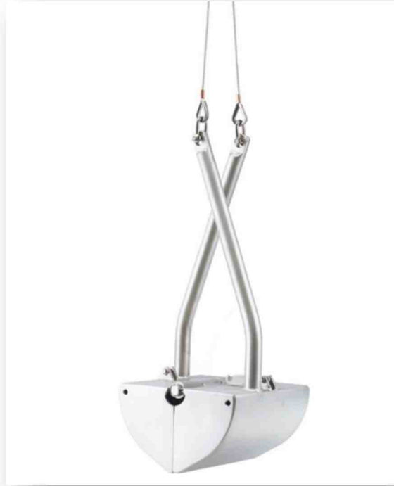
Kuva 13. GEMAX-sedimenttinäytteenotin (vasemmalla) ja Van Veen -pohjaeliöstönäytteenotin (oikealla).
