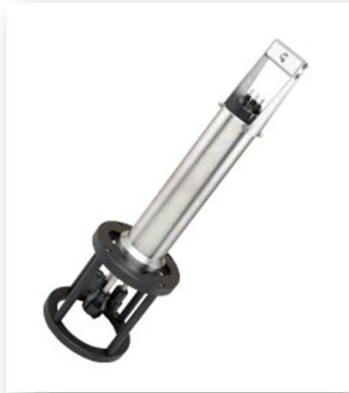
Kuva 12. Rinko CTD -profilointimittauslaite suolapitoisuuden, lämpötilan, syvyyden, sameuden ja happipitoisuuden pystysuoran jakauman mittaukseen.
