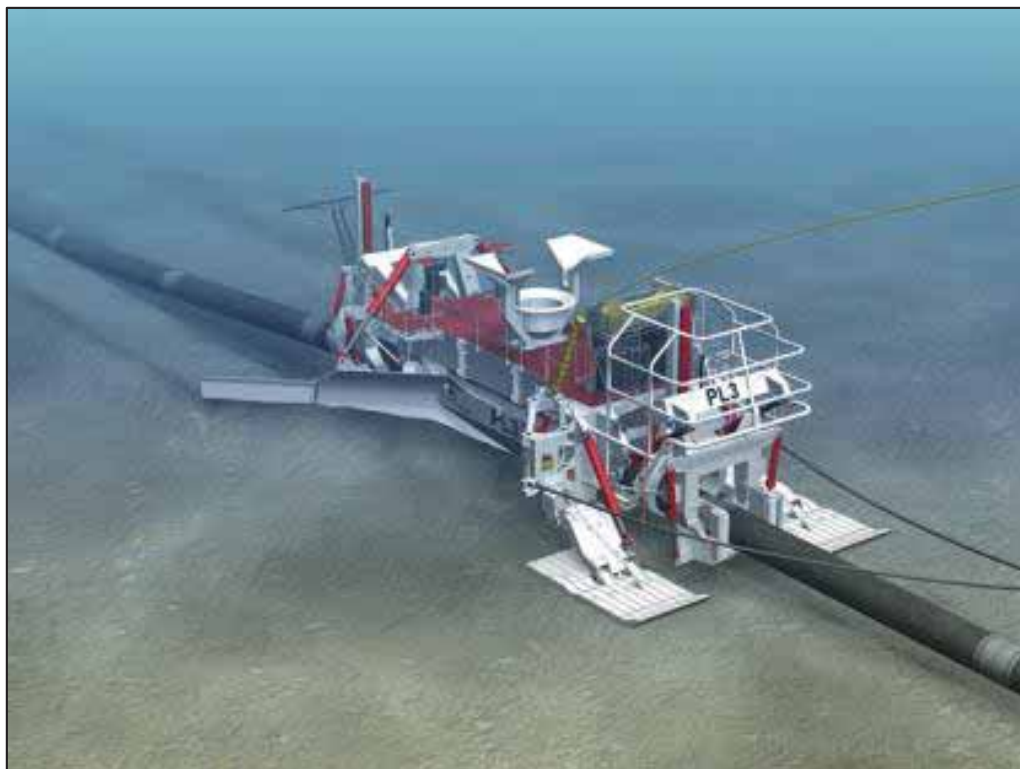
Kuva 6-15 Putkiaura toiminnassa merenpohjalla.
