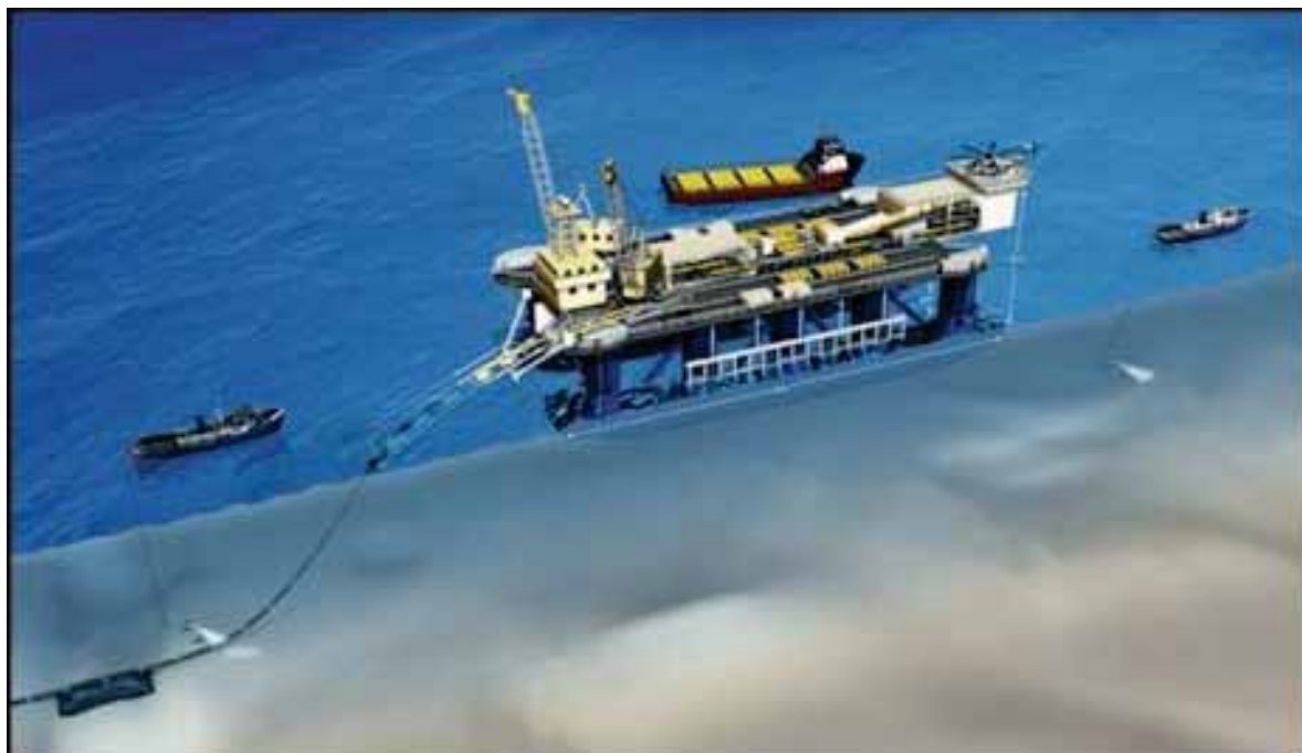
Kuva 6-11 S-asennukseen käytettävä putkenlaskualus ja tutkimusalukset.
