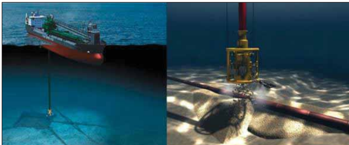
Kuva 6-17 Kiviaineksen läjitys merenpohjaan laskuputkea käyttämällä.
