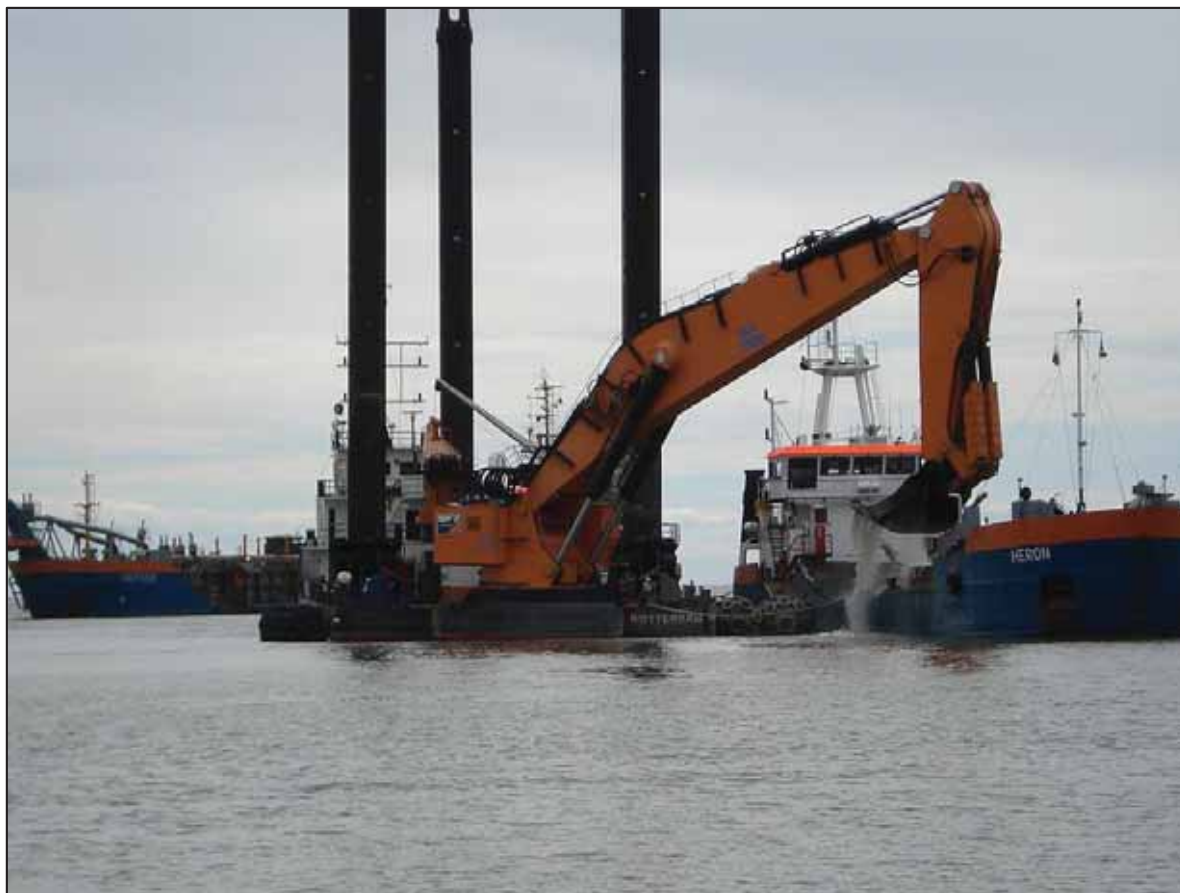
Kuva 6-16 Kauharuoppaaja, jonka viereen on ankkuroitu palkoproomu (oikealla).
