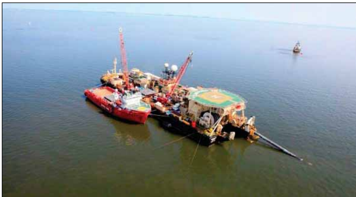
Figur 6-22 Typiskt rörlägningsfartyg för grunt vatten (med bogserare för ankarhantering och rörtransportfartyg).
