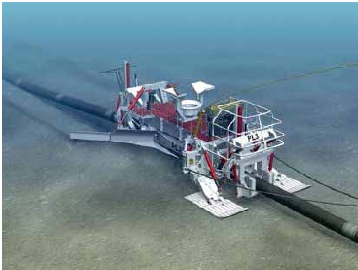
Figur 6-15 Rörledningsplog i arbete på havsbotten.
