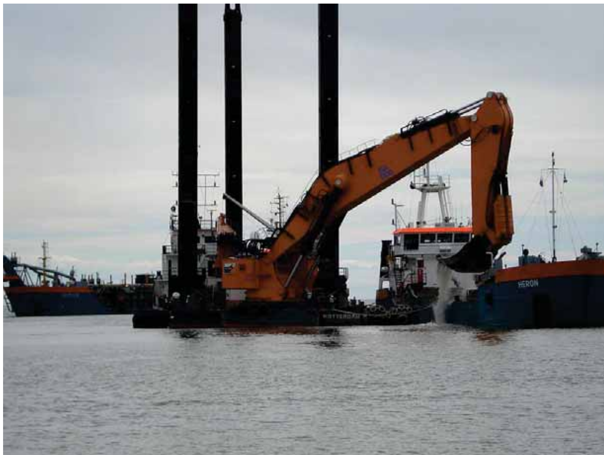
Figur 6-16 Mudderverk med delad mudderpråm förtöjd jämsides (höger).
