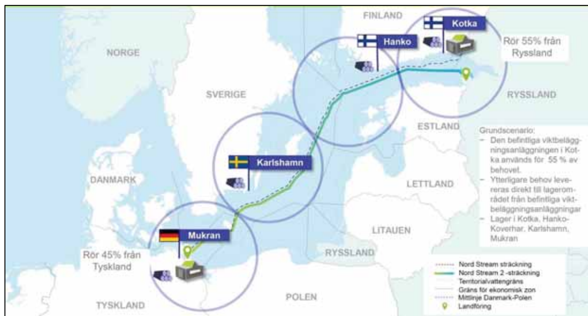
Figur 4-14. Rörledningslogistik Nord Stream 2.
