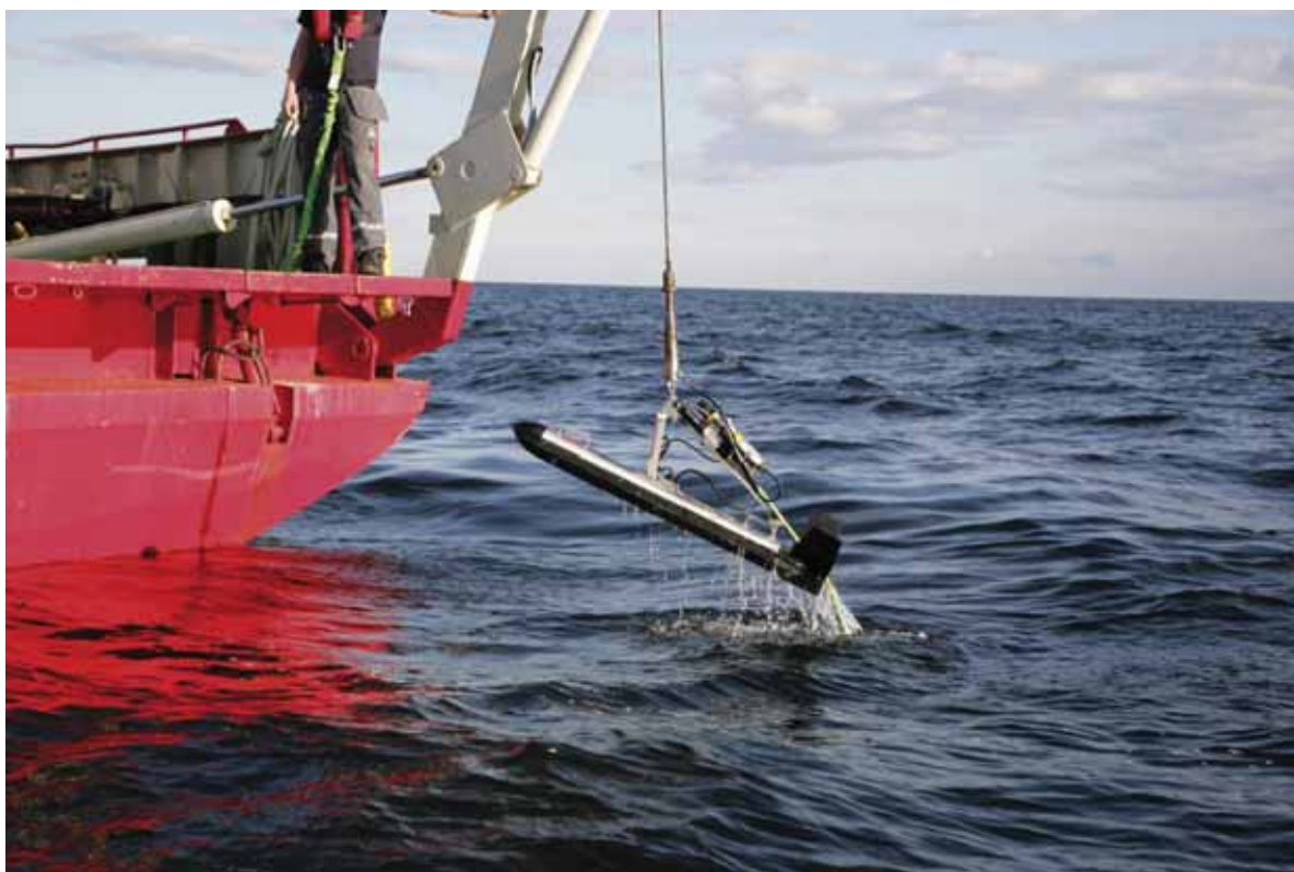
Figur 4-5. Sidoseende sonar (SSS) används i geofysiska undersökningar. Foto: Nord Stream AG.
