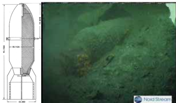
Figur 7-59. Rysk flygbomb av typ FAB-100 med 42 kg laddningsvikt, introducerad 1940 och brett använd i andra världskriget. Totalt 11 bomber av den här typen röjdes under Nord Stream-projektet (Witteveen+Bos 2011).
