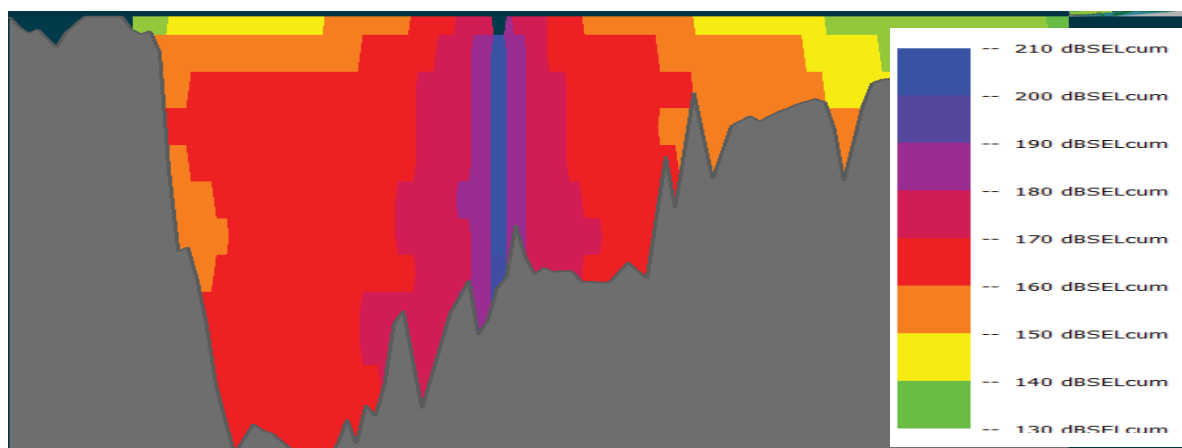
Figur 11-21. En förklarande figur som visar hur undervattensbuller fortplantas mer effektivt i de djupa vattnen än på ytan. Exempel på en vertikal plot av ljudets fortplantning vid krigsmaterielröjning (färgskala) i förhållande till djupet (Y-axel, 80 m) och avståndet (X-axel, 50 km). Figur tagen från rapporten av undervattensbuller (Ramboll 2016d).
