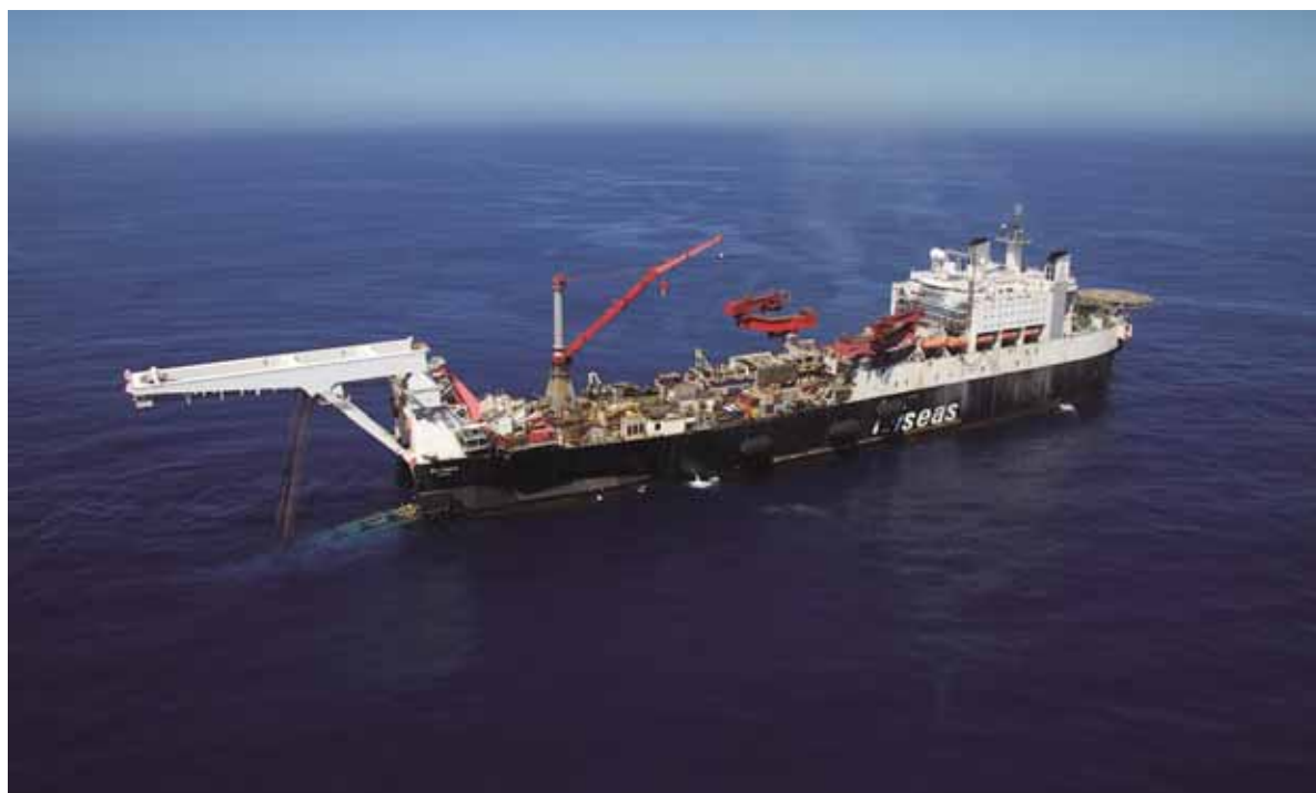
Figur 4-10. S-rörlägningsfartyget med stödartyg för undersökning. Foto: Nord Stream AG
