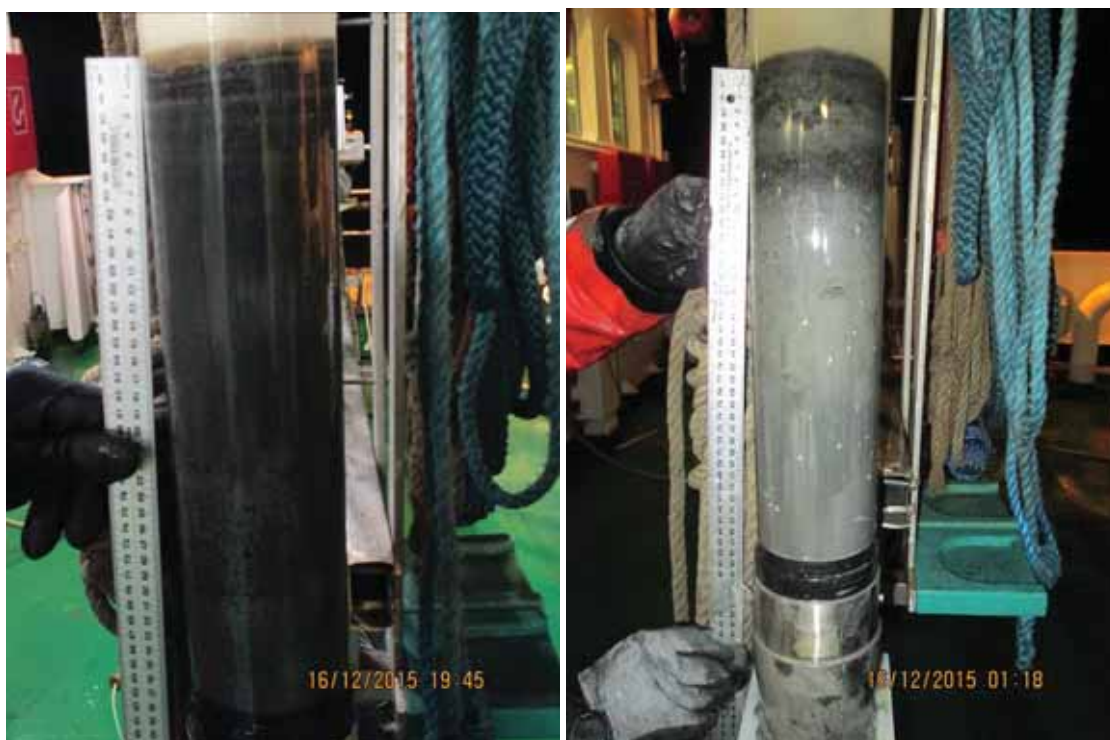
Figur 7-6. Sedimentprofiler vid områdesstationerna FIN_EBS_LUO_5 och 7 (Figur 7-7). Vattendjupet var 71 m (vänster bild) och 111 m (höger bild).
