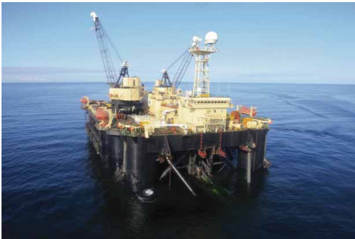
Figur 4-12 Ankarpositionerat rörlägningsfartyg – Castoro Sei. Foto: Nord Stream AG
