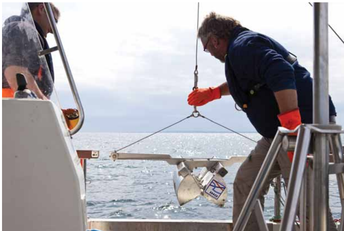
Figur 4-21. Van Veen-provtagare som används vid bentosprovtagning. Foto: Nord Stream AG.
