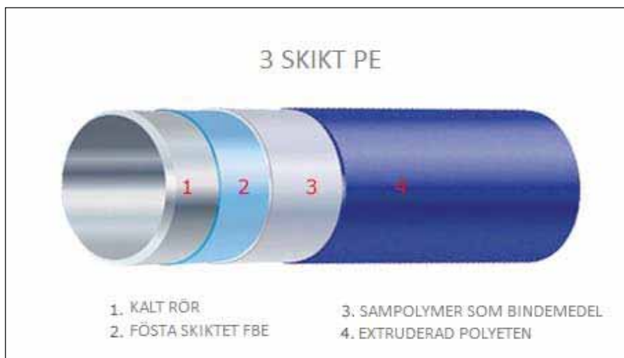
Figur 4-3. Korrosionsskyddande beläggning med tre skikt.
