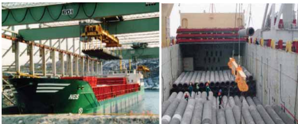
Figur 4-15 Lastning av belagda rör på ett rörtransportfartyg. (Foto: Nord Stream AG)
