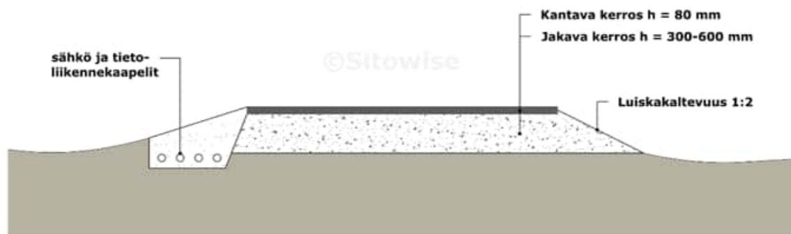
Periaatekuva uuden ja perusparannettavan tien rakenteesta.
