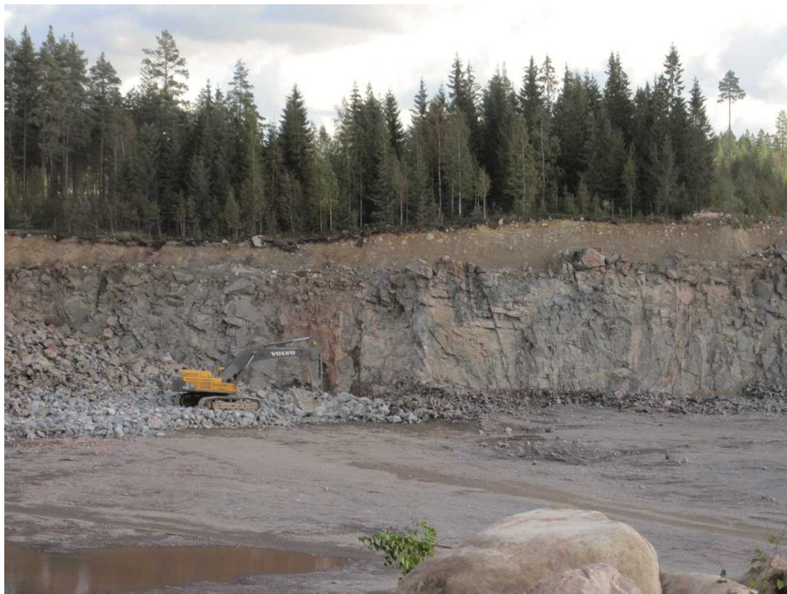
Kuva 3-10 Kuvassa louhittava rintausta, josta rikotettu louhe kuljetetaan murskattavaksi
