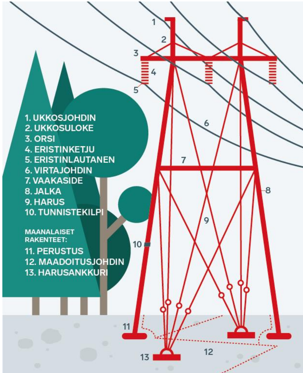
Kuva 3-5. Voimajohdon osat (Fingrid 2024).
