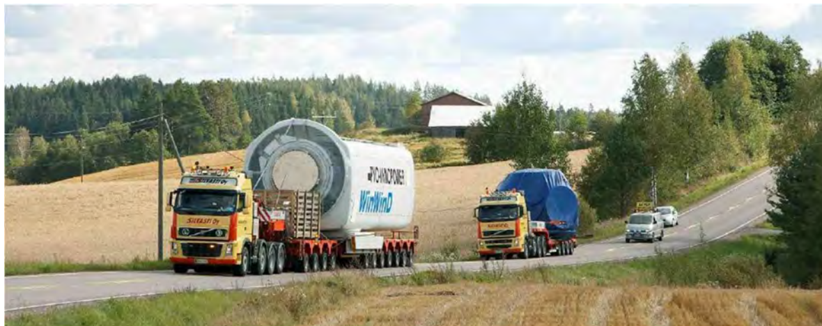
Kuva 133. Tuulivoimalan konehuoneen ja navan erikoiskuljetukset (Ville Silvasti Oy).
