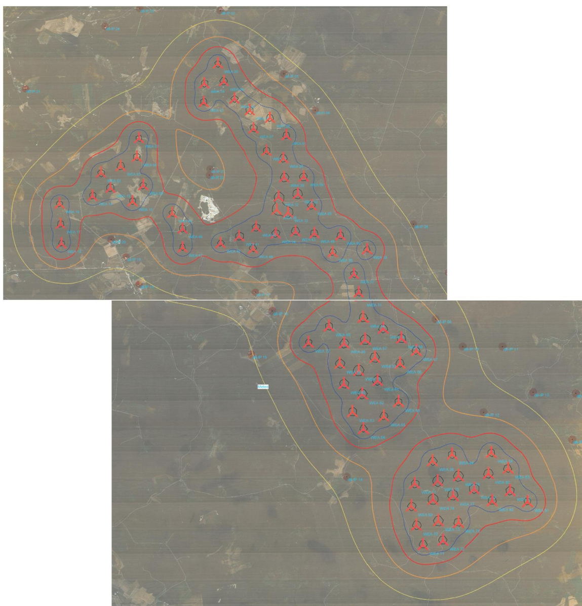
Kuva 57. Hankkeen alkuvaiheen melumallinnus, jossa uloimpana puskurina on 35 dB:n raja. Meluarvo kasvaa 5 dB:n vyöhykevälein siirryttäessä lähemmäksi tuulivoimaloita. Melumallinnus laaditaan uudeen sijoitussuunnitelman täsmennyttyä.
