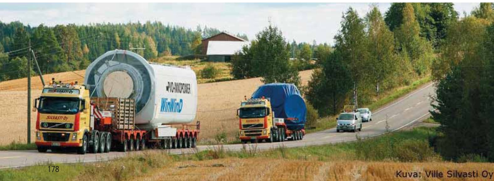
Figur 19-8. Specialtransporter av vindkraftverkens maskinhus och nav.
