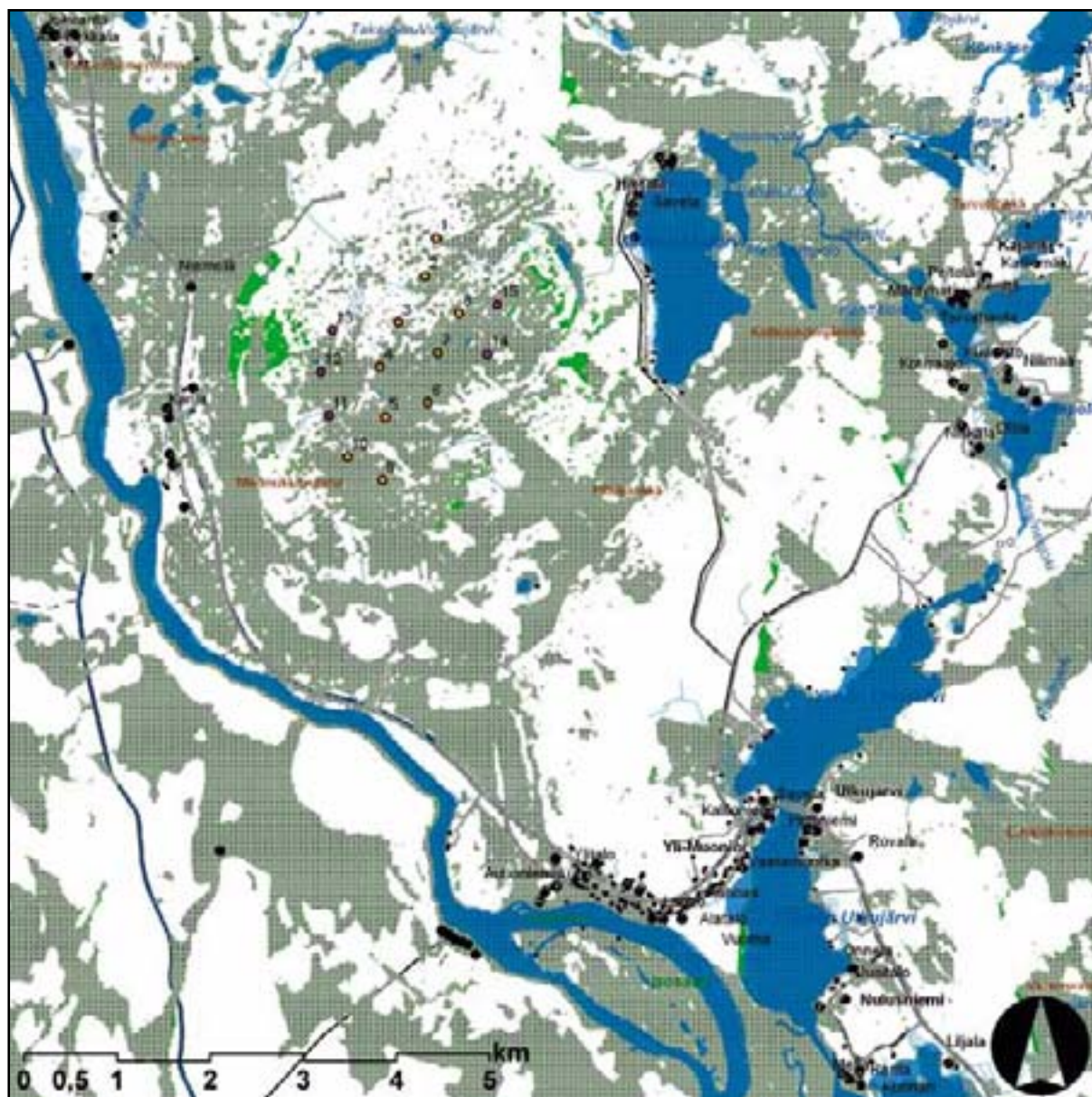
Kuva 8-36. Karttaote: Näkemäalueiden erot VE 1:n ja VE 2:n välillä. Ne alueet, joille näkemäalueanalyysin perusteella näkyy tuulivoimaloita vaihtoehdossa 1 muttei vaihtoehdossa 2, on osoitettu kartalla vihreällä. Alueet, joille näkemäalueanalyysin perusteella näkyy tuulivoimaloita sekä vaihtoehdossa 1 että 2, on osoitettu kartalla harmaalla rasterilla (näkemäalueet ulottuvat myös vesistöjen päälle).
