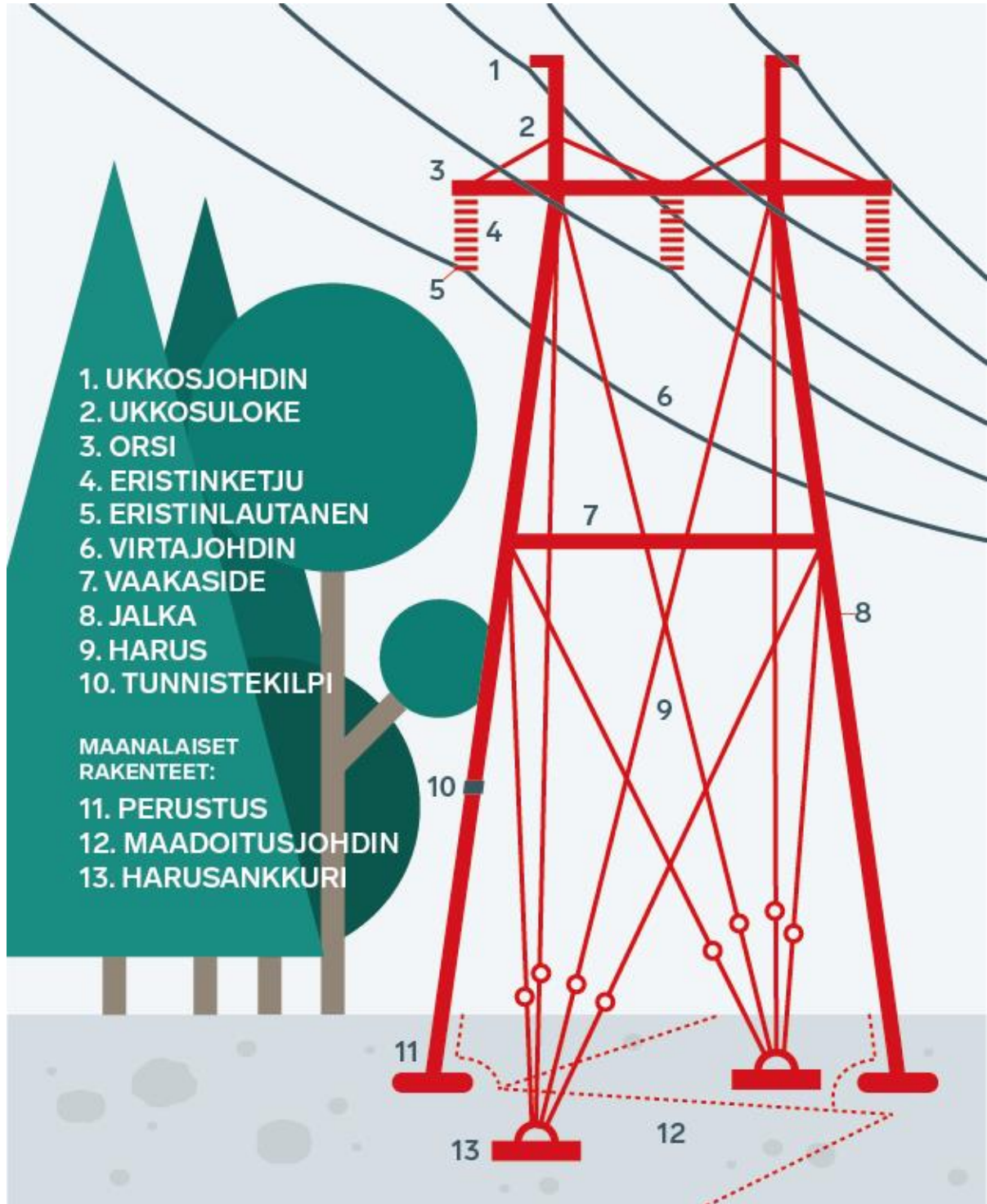
Kuva 4-4. Voimajohdon rakenne (Fingrid 2020).
