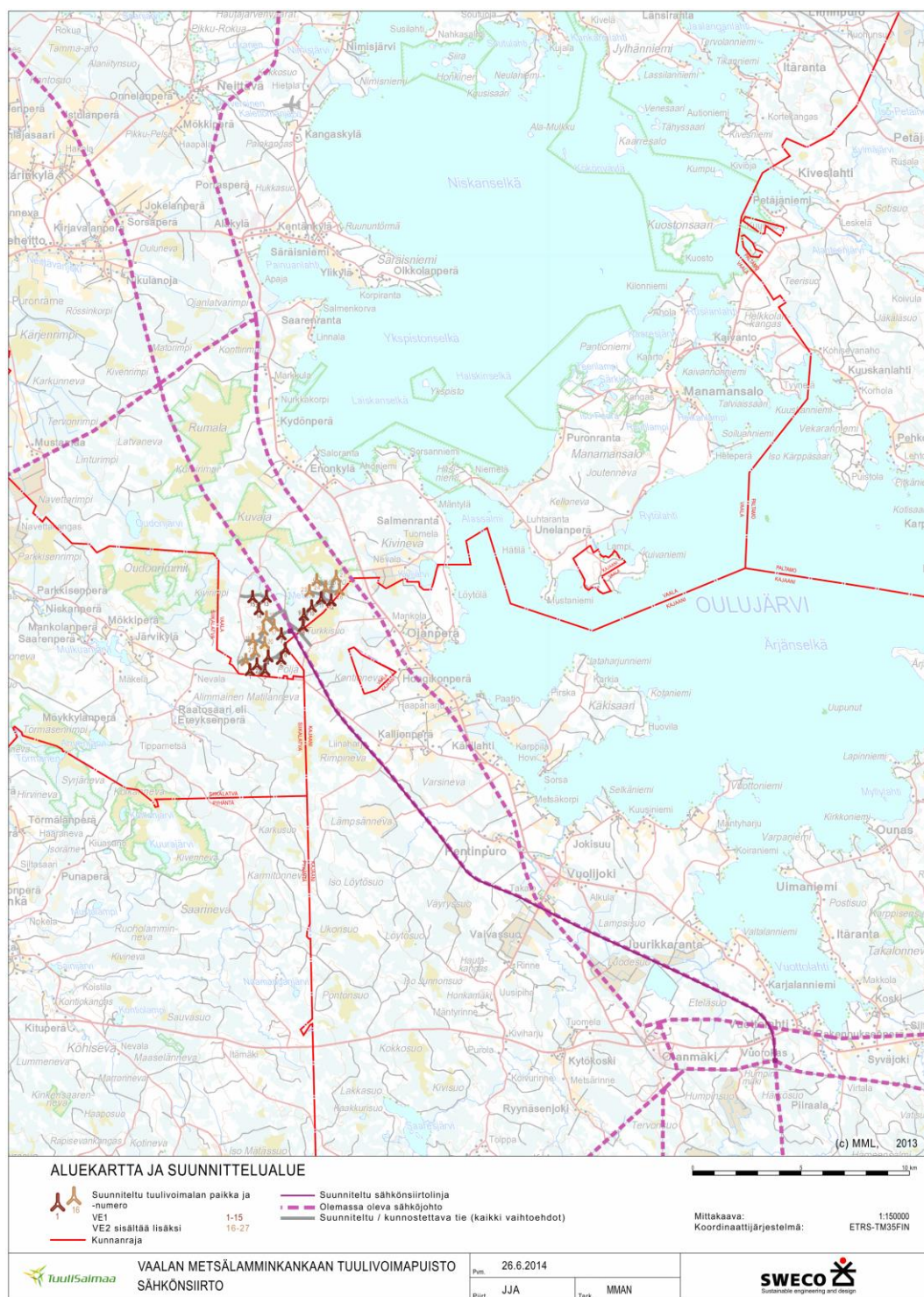
Kuva 19. Metsälamminkankaan tuulipuiston verkkoliittynän esisuunnitelmakartta.
