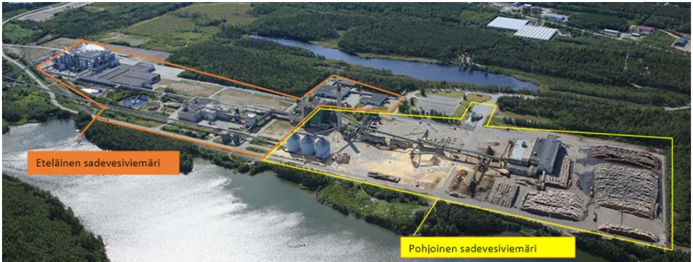
Kuva 3.1-1. Hulevesien keräily ja johtaminen nykytilanteessa.
