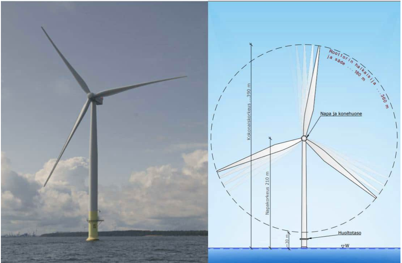
Kuva 2-7. Vasemmalla kuva merituulivoimalasta ja oikealla arvioitavan tuulivoimalan mitat. (Kuva: Arenso Oy, 2025)
