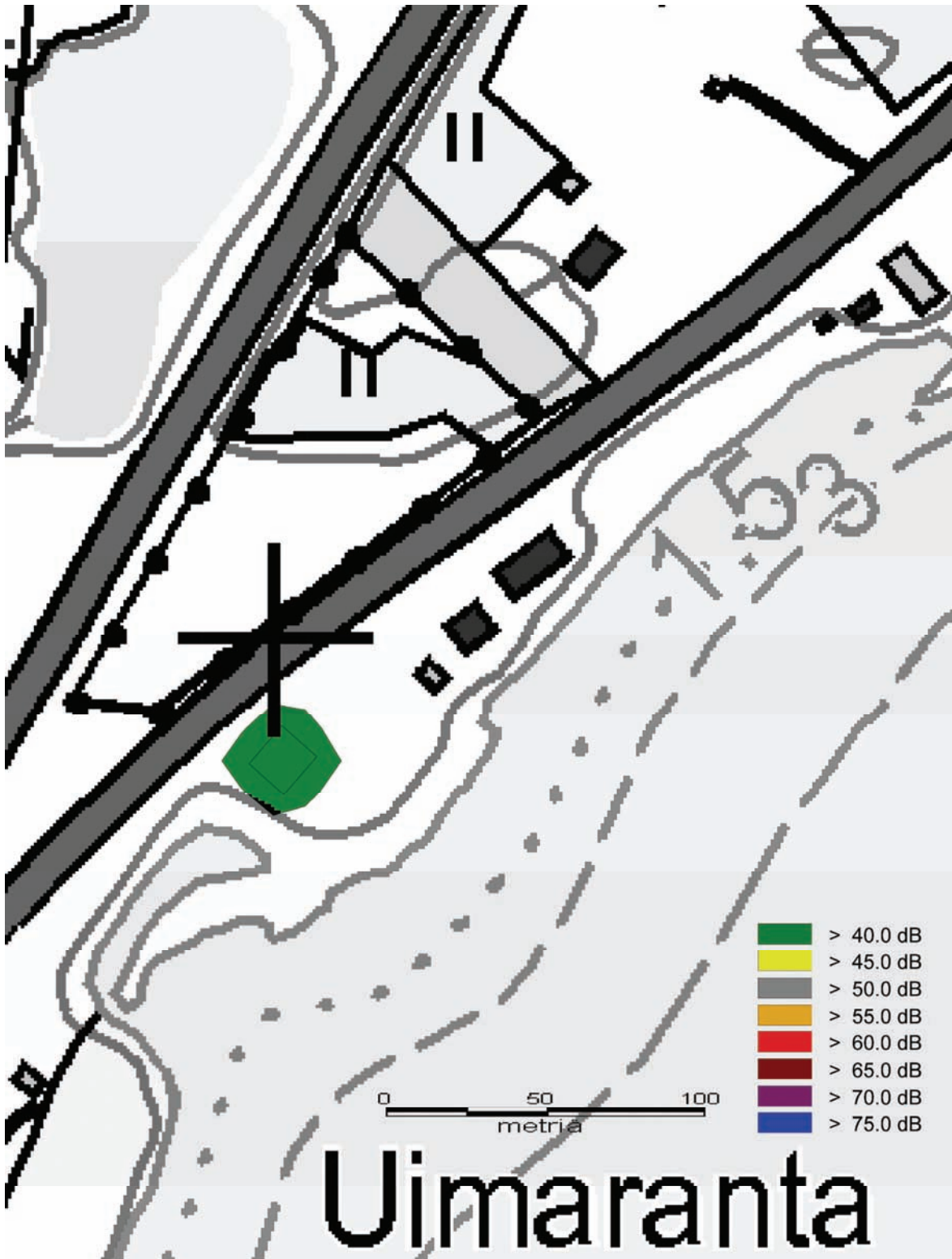
Kuva 5. Suunnitellun jäähdytysvesipumppaamon toimintojen aiheuttaman A-painotetun keskiäänitason ( L_{Aeq} [dB]) vyöhykkeet. Oletuksena mallinnuksessa on, että maan pinta on ääntä absorboiva ja vesistöt ääntä heijastavia. Laskennallisesti arvioidut melutasot ovat mahdollisia melun leviämisen kannalta suotuisissa olosuhteissa kuten tilanteissa, joissa tuuli on melulähteeltä kohteen suuntaan. Alkuperäisen kartta-aineiston mittakaava on 1:4000.
