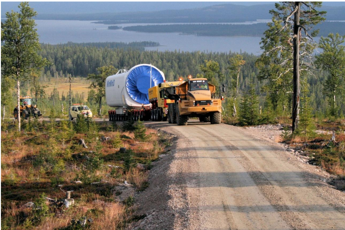
Kuva 4-7. Tuulivoimalaitoksen koneiston kuljetusta (kuva: WinWinD, www.winwind.com ).
