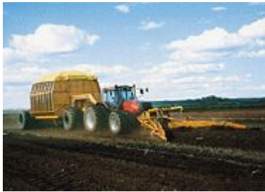
Kuva 4-4. Kokoojavaunumenetelmän karheamisen ja kokoamisen työvaihe. Lähde: Vapo Oy.
