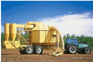
Kuva 4-6. Kokoaminen imuvaunulla. Lähde: Vapo Oy.
