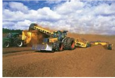
Kuva 4-3. Hakumenetelmän karheamisen (vasen kuva) ja kuormauksen työvaiheet. Lähde: Vapo Oy.
