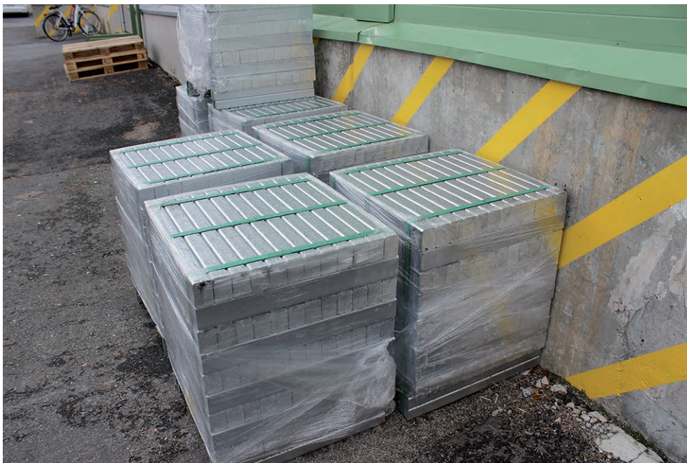
Kuva 3-4. Alumiiniseosharkkoja valimon seinustalla.
