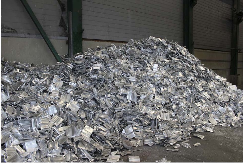
Kuva 3-3. Profilituotannon alumiiniromua varastoituna valimon tiloissa.
