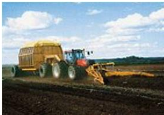
Kuva 3-4. Kokoojavaunumenetelmän karheami- sen ja kokoamisen työvaihe (Vapo Oy 2012).
