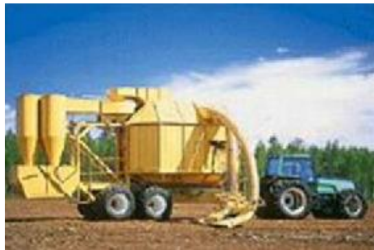
Kuva 3-3. Palaturpeen nosto (Vapo Oy 2012).
