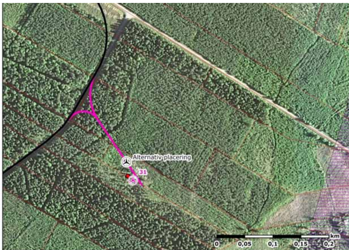
Figur 21.3. Alternativ placering av kraftverk nr 31, så att fornlämningen kan lämnas utanför byggåtgärderna.
