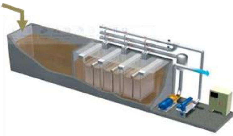
Kuva 2-14. Esimerkki membraanibioreaktorista (MBR).
