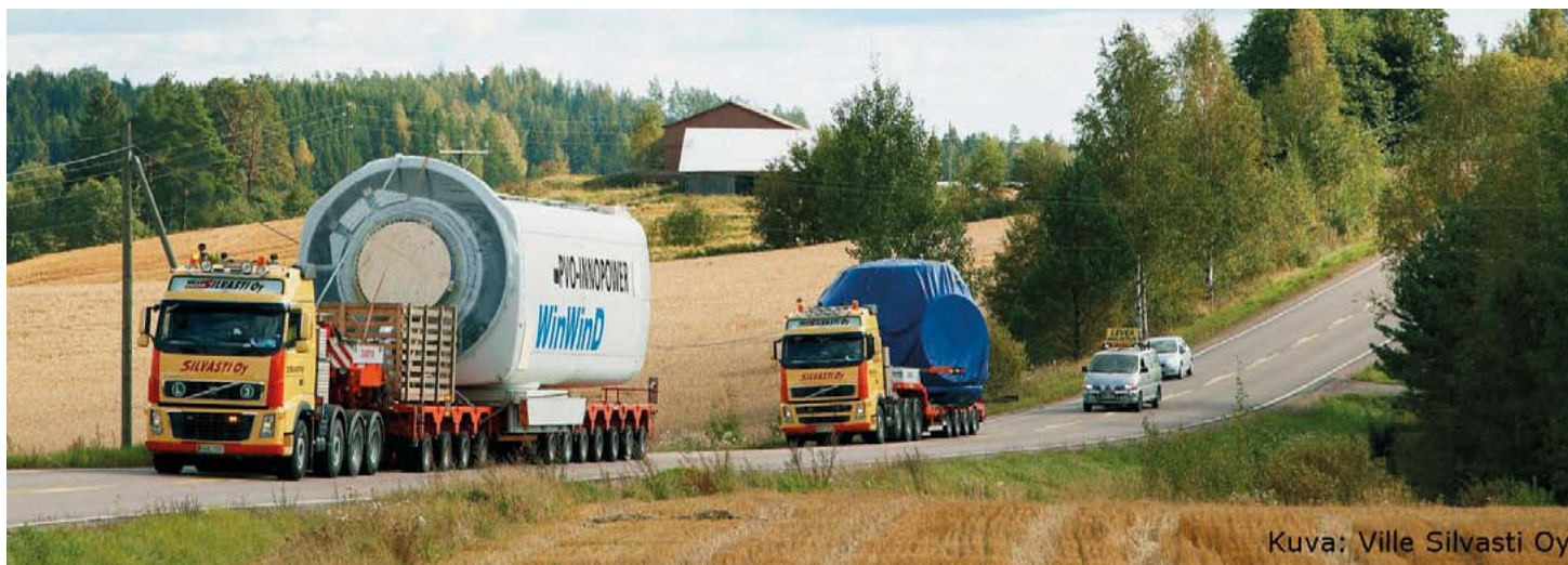
Kuva 18-8. Tuulivoimalan konehuoneen ja navan erikoiskuljetukset.
