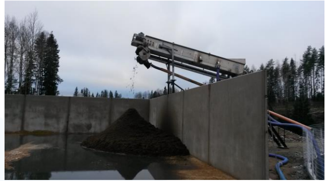
Kuva 32. Separaatilla eroteltua lietelantaa. Puristuksessa erottuva nestemäinen jae johdetaan lietesäiliöön.
