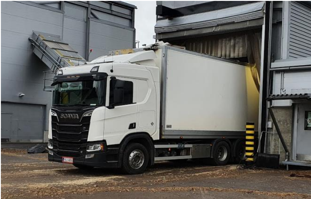
Kuva 2. Peräpurkurekka hakekentän purkupaikalla.
