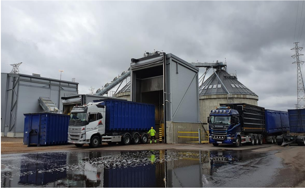
Kuva 1. Kuvassa on kaksi peräkippirekkaa hakekentällä, joista valkoinen on vastaanottorakennuksen purkupaikalla ja sininen odottaa vuoroaan. Jokaiseen rekkaan kuuluu kolme konttia: valkoisen rekan 1. kontti on tyhjennetty ja laskettu kippauspaikan viereen, 2. kontti on rekassa purkupaikalla ja 3. kontti odottaa rekan peräkäräystä.
