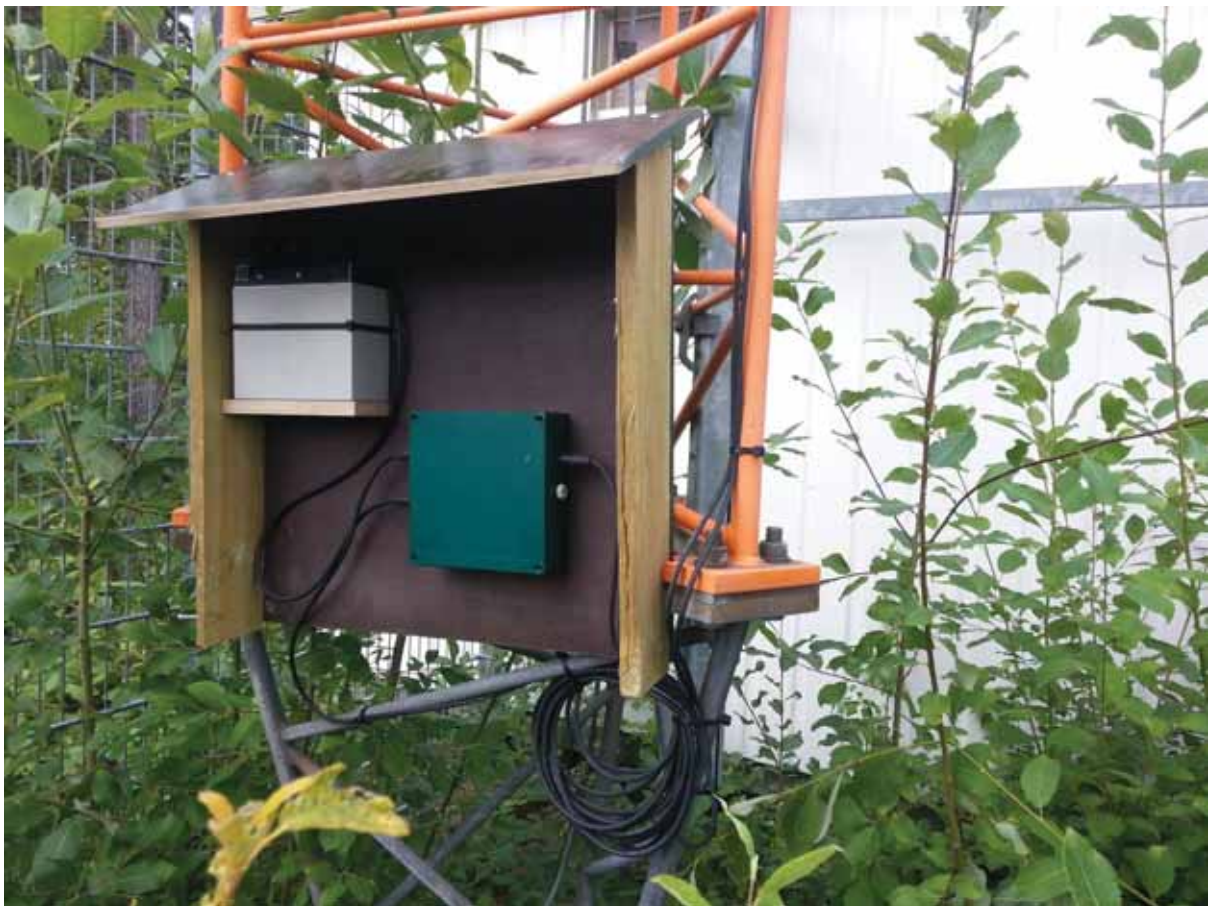
Kuva 4. Ultraäänitallennin ja akku Rosendalin GSM-mastossa.
