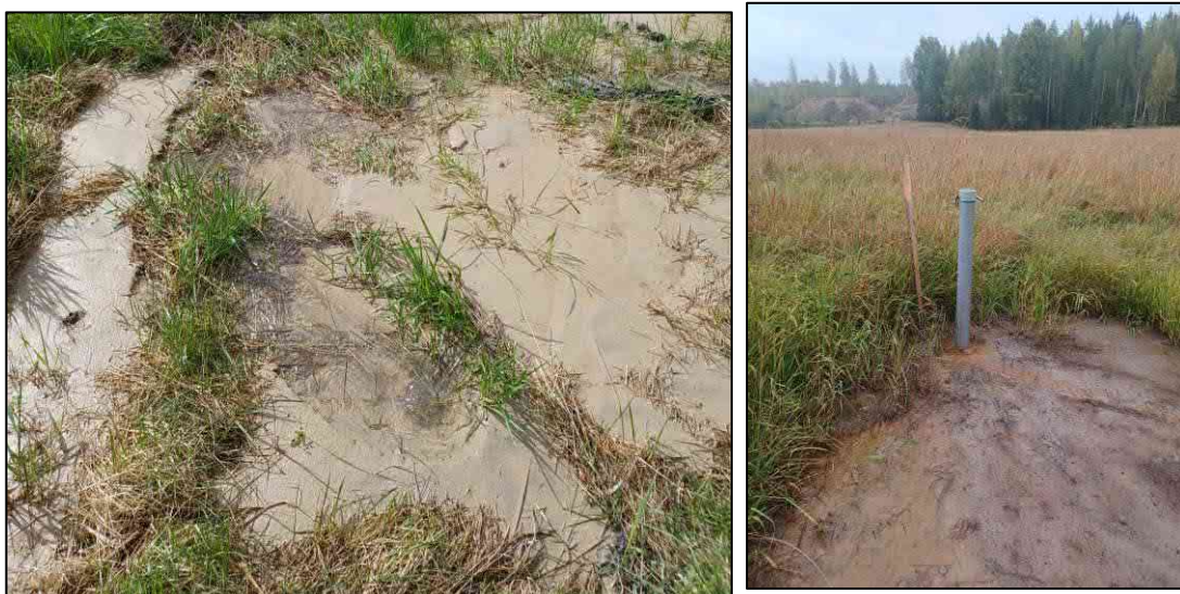
Kuva 9. Arteesisen pohjaveden vaikutus sisäänkäynnin alueella. Vuotava vanha kairausreikä vasemmalla ja vuotava tarkkailuputki oikealla.
