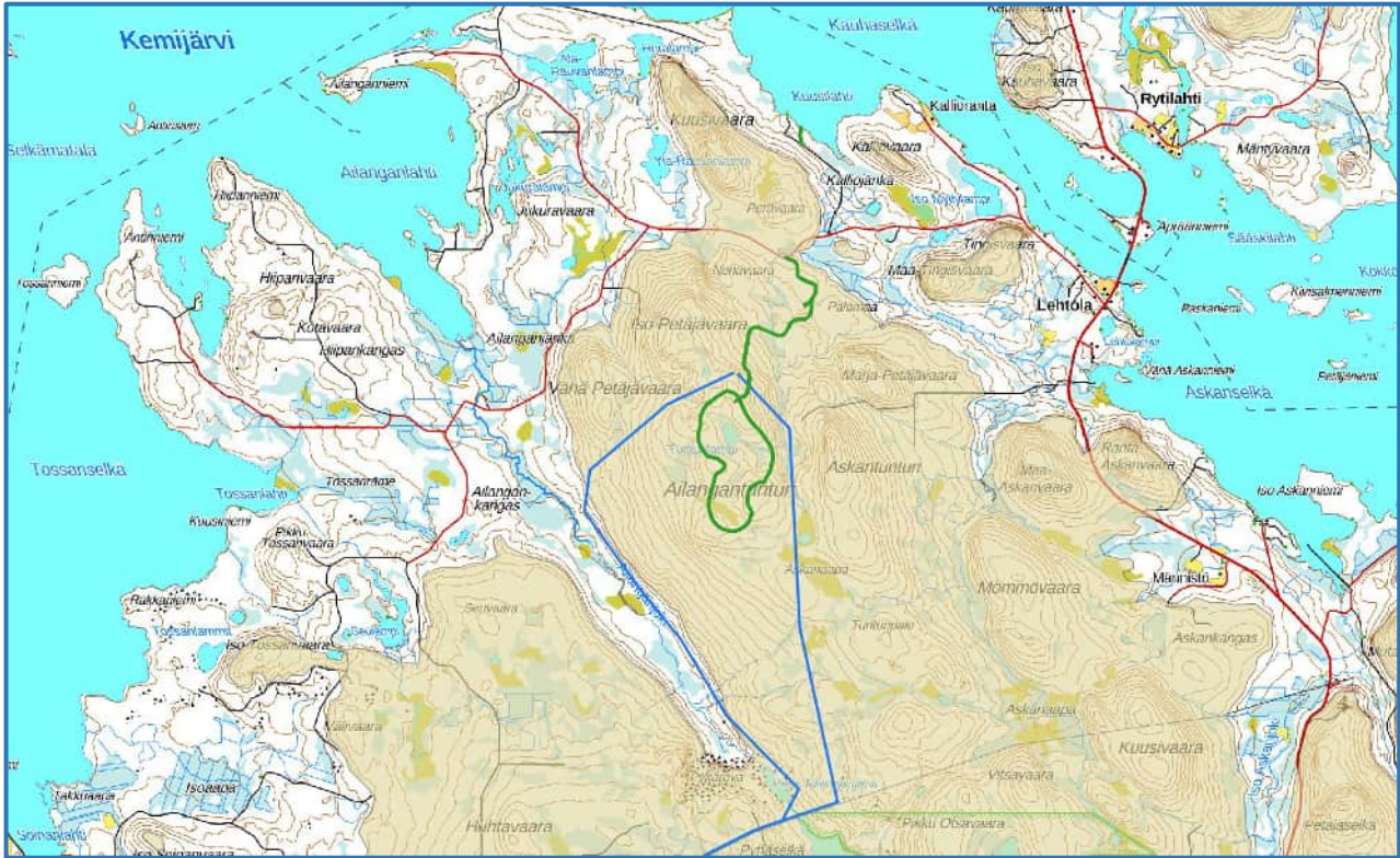
Kartta 7. Vedenkoskemattomat alueet, eli Ancyclusvaiheen korkein ranta Ailangantunturin alueella on merkitty karttaan ruskealla. Karttaan on merkitty vihreällä suunniteltu yläallas sekä tiestö ja sinisellä suunnitellut vaihtoehtoiset voimajohtolinjat. Kartta NMG Oy, data GTK.
