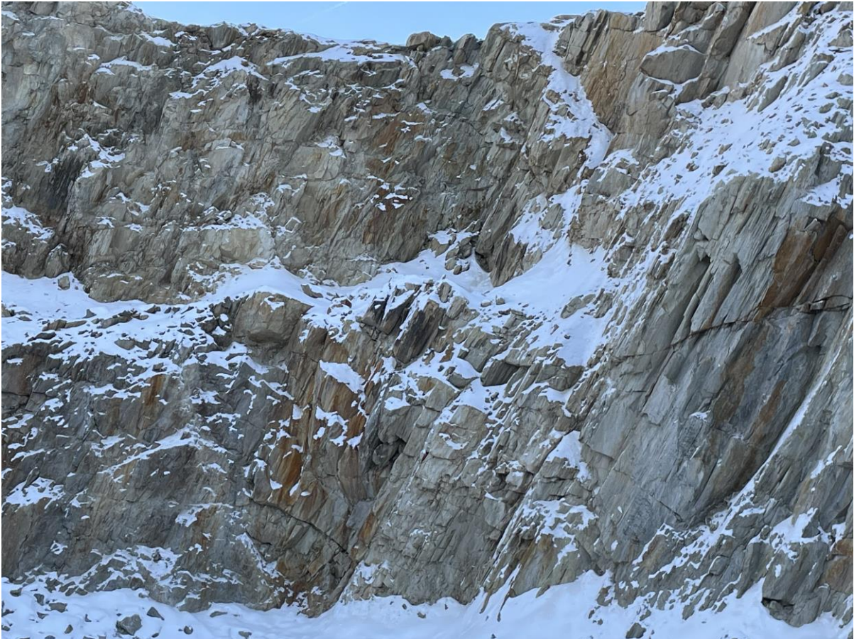
Kuva 4-19. Rakoilua avolouhoksen seinämissä.
