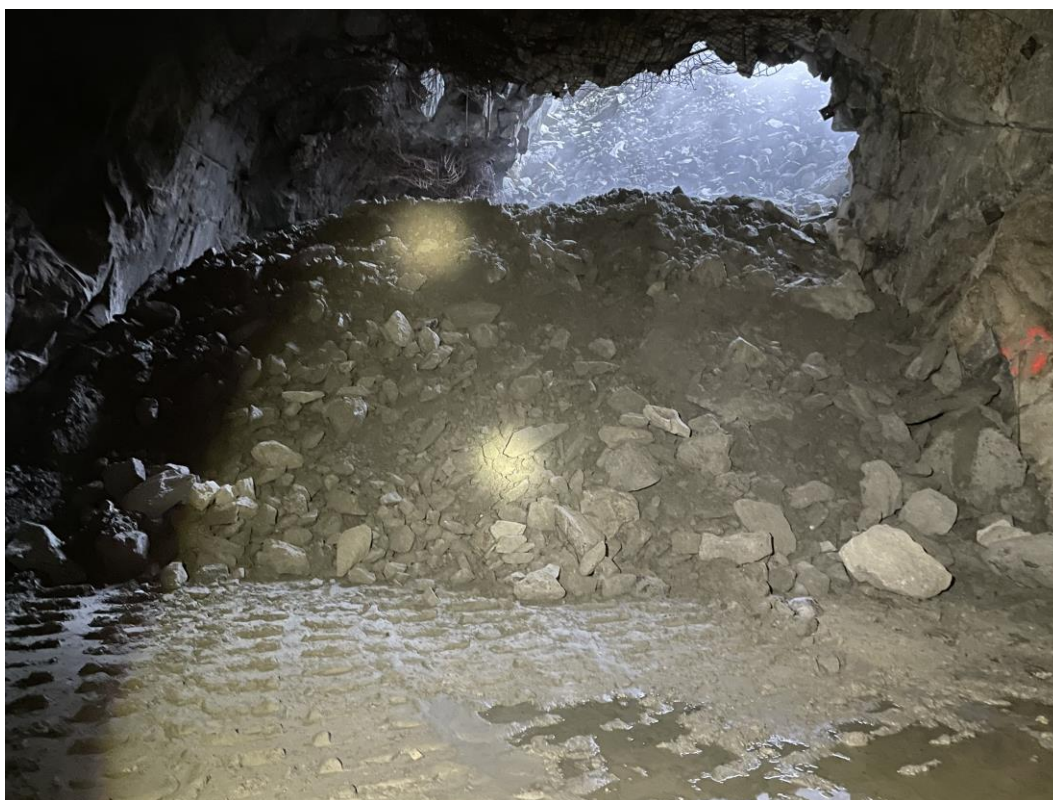
Kuva 4-25. a) Avolouhoksesta on yhteys maanalaisiin louhittuihin tiloihin, b) louhitut tilat täytetään.
