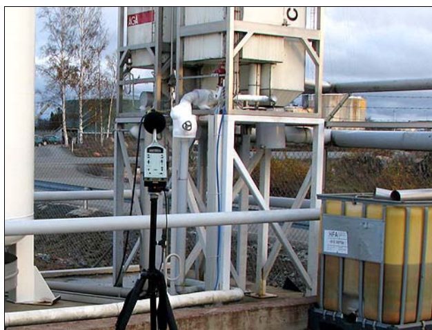
Kuva 1. Ei voitu mitata, mutta mukana laskennassa: Bolidenin pumput ja St1:n VRU. Melupäästötiedot ovat peräisin samanlaisten laitteiden muualla tehdyistä päästömittauksista.
