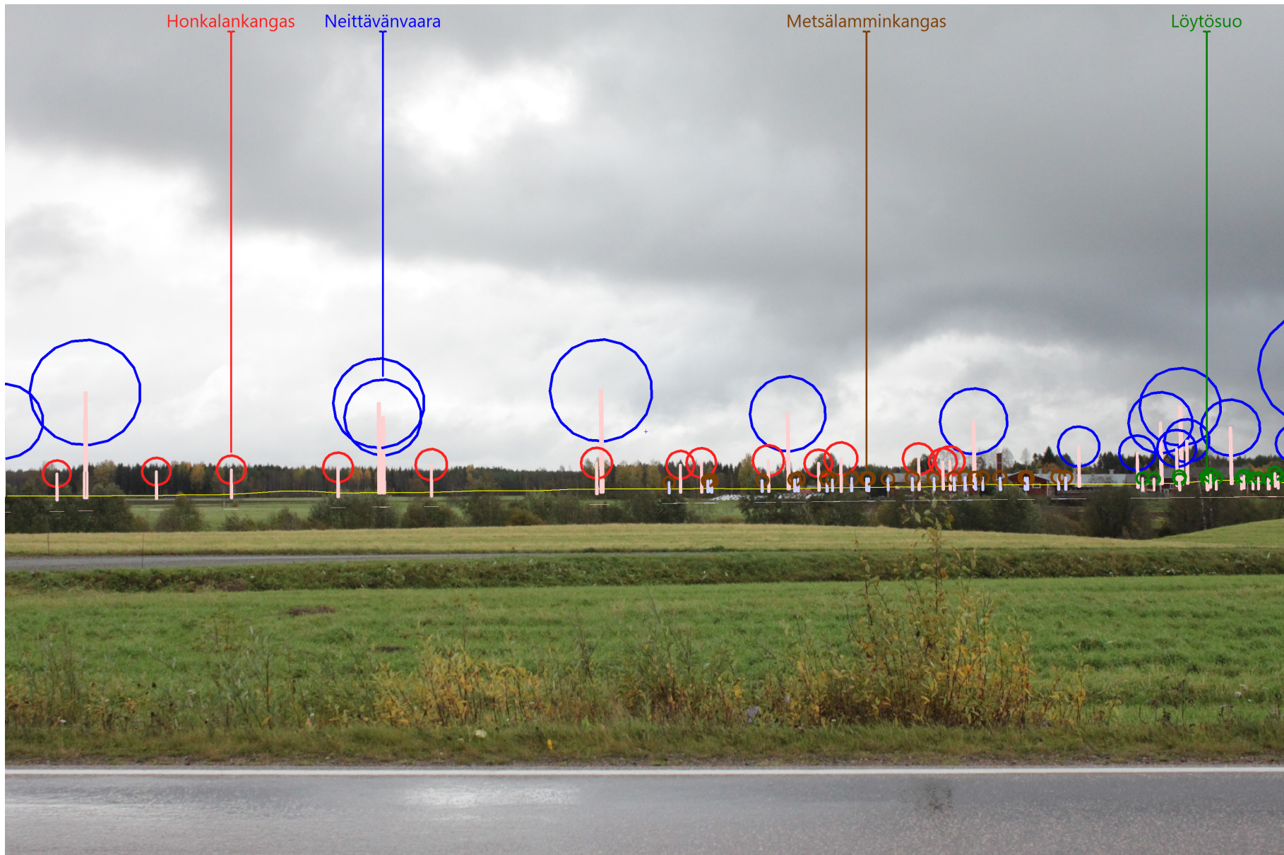
Tuulivoimaloiden sijoittumisen rautalankamalli, pyörähdysala ja numerointi.
