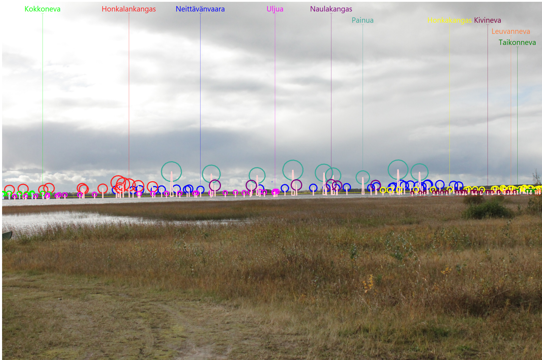
Tuulivoimaloiden sijoittumisen rautalankamalli, pyörähdysala ja numerointi.
