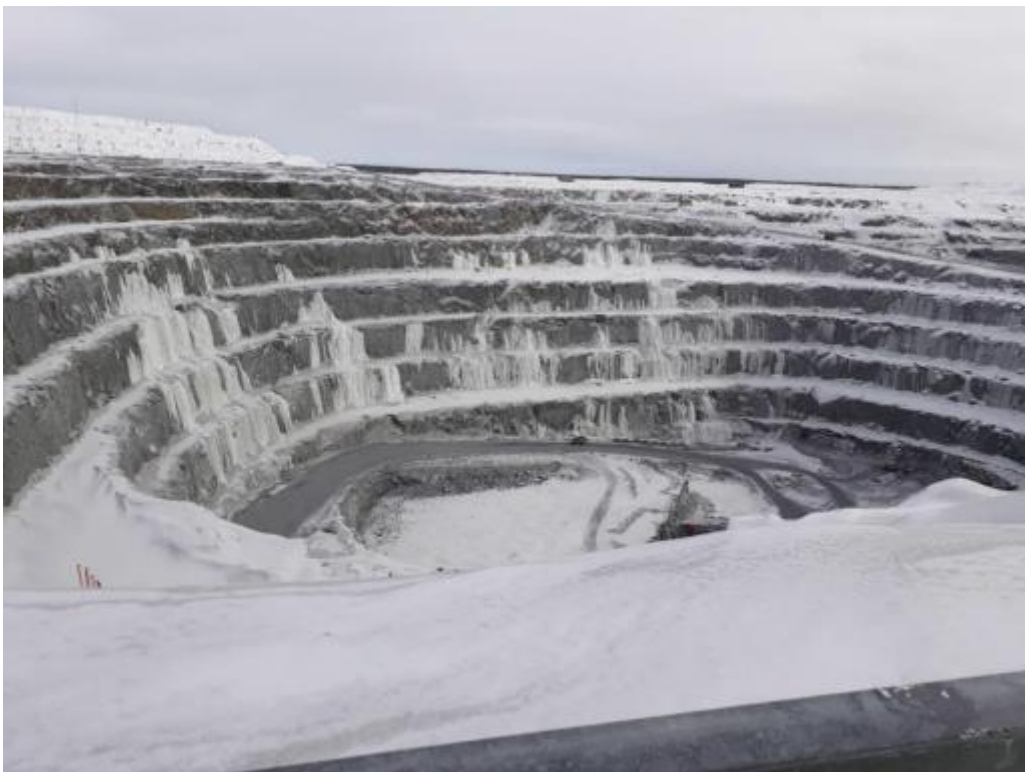
Kuva 215. Kuvitus pohjaveden parhaiten kehittyneestä virtaussunnasta kallioperän rakenteissa; kuva avolouhoksen seinämästä talvella 2018, katsottuna itään (Golder, 2018).
