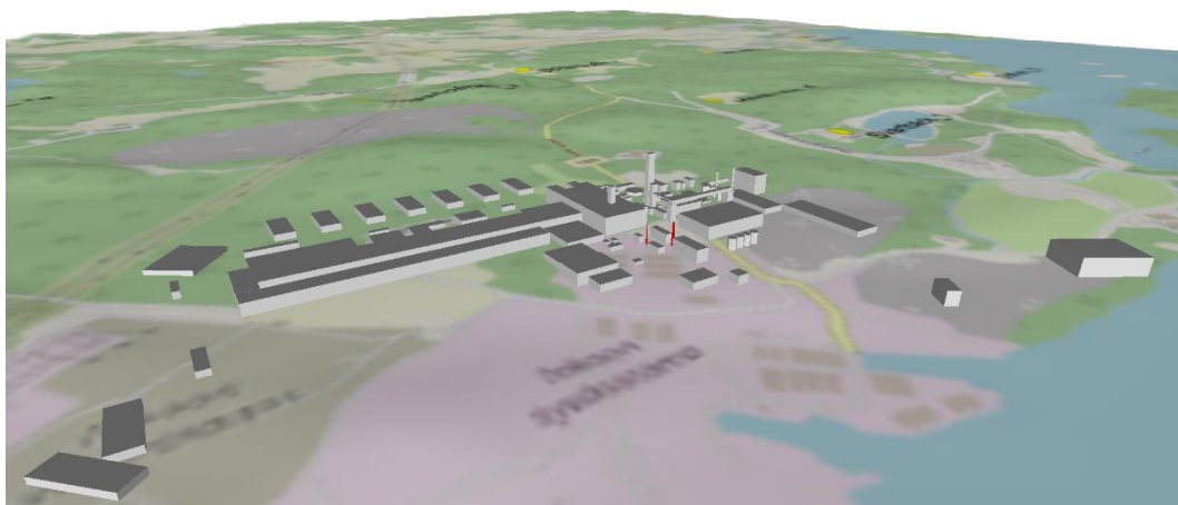
Kuva 3. Ilmapäästöjen leviämismalliin kolmiulotteisina kappaleina määritetyt tehdasalueen rakennukset (harmaa) ja päästölähteinä käytetyt piiput (punainen). Näkymä lounaasta kohti Inkoon keskustaa.
