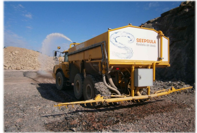
Kuvat 8 ja 9. Lähtevien kuormien kastelujärjestelmä ja alueella kiertävä kasteludumpperi
