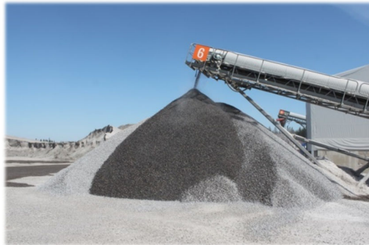
Kuva 20 ja 21. Hiekkoitushiekan kuljettimen pää hallissa. Kuljetinten päissä oleva kastelu estää tehokkaasti kiviainekasojen pölyämisen.
