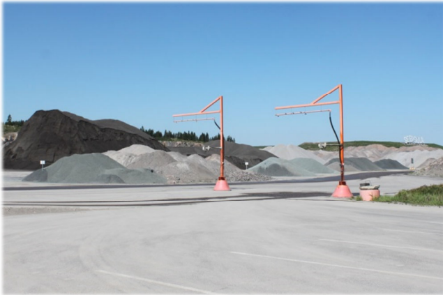
Kuvat 8 ja 9. Lähtevien kuormien kastelujärjestelmä ja alueella kiertävä kasteludumpperi
