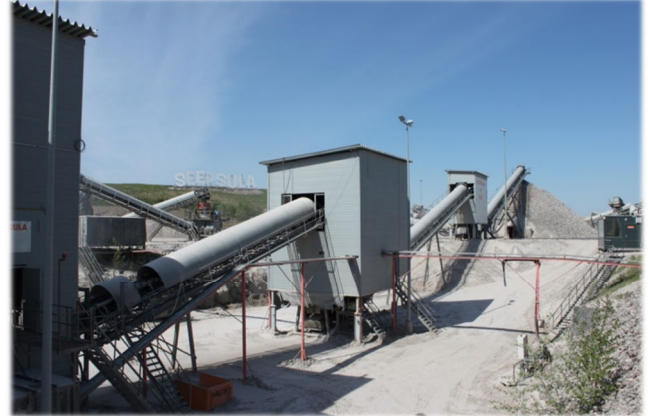
Kuvat 13 ja 14. Syötin, primäärilinjain koteloidut murskaimet ja seula sekä koteloidut kuljettimet. Kuvassa näkyvissä syöttimen korkeapainekastelujärjestelmä ja korotetut laidat ja kuorman tyhjentämistä odottava kiviauto.
