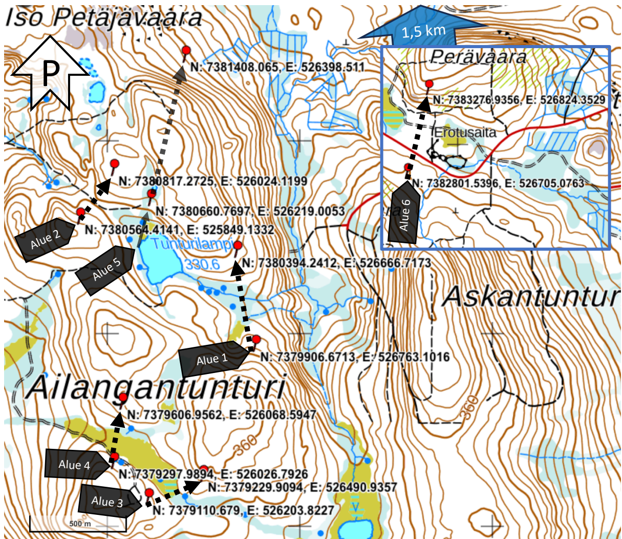
Kuva 1 Kohdealueella suoritettut mittaukset tunnistetietoineen on visualisoitu kartan päällä suuntaa antavasti mustilla katkoviivanuolilla. Punaiset ympyrät – ja näiden yhteydessä olevat koordinaatit (ETRS-TM35) –kuvaavat mittausten alku- ja loppupisteitä. (Kartta: Paikkatietoikkuna.)
