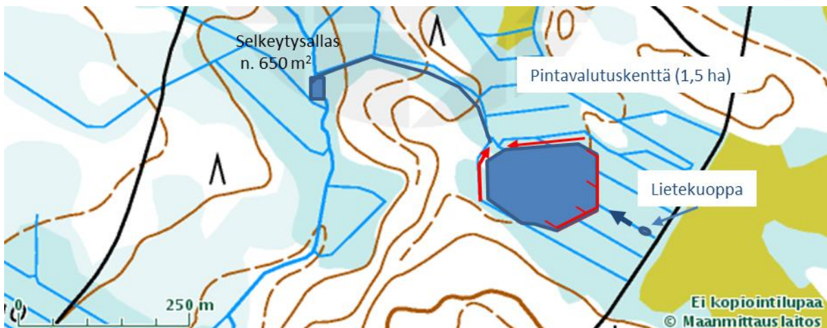
Kuva 4 Rikastushiekka-altaan viereen mahdollisesti rakennettava pintavalutuskenttä.
