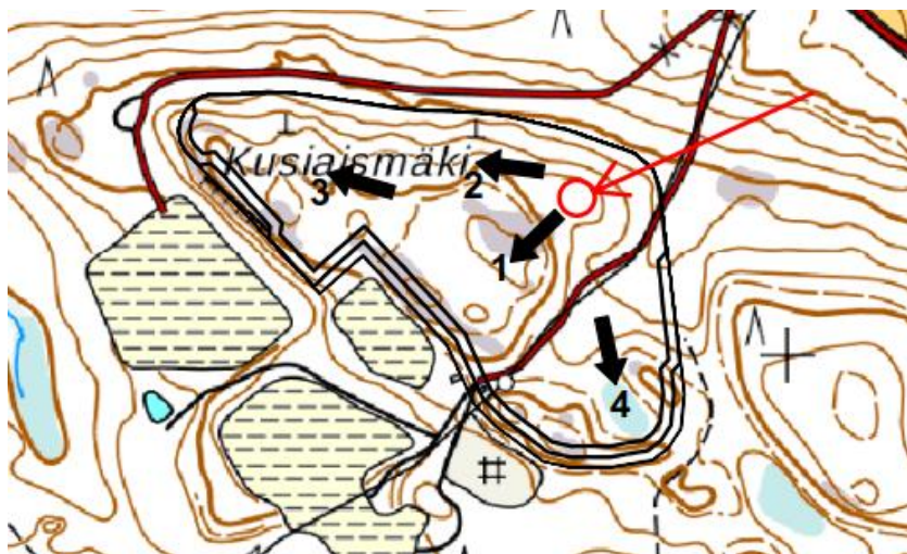
Kuva 2. Louhinnan aloituskohta esitetty punaisella ympyrällä ja louhinnan eteneminen numeroiduilla nuolilla. Pohjakartta Maanmittauslaitoksen aineistoa.
