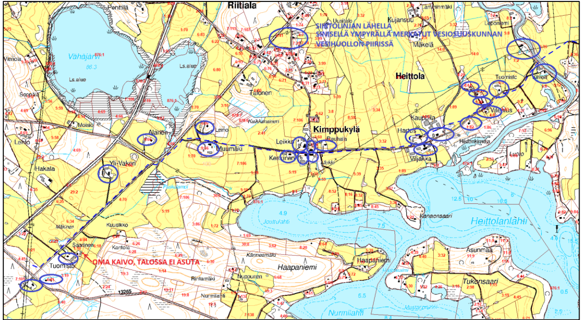
Kuva 2.3. Maakaapelina toteutettavan todennäköisen sähkösiirron linjauksen (VE A) läntinen osa. Kuvaan on merkitty linjan lähellä sijaitsevat vesiosuuskunnan vesihuollon piirissä olevat kohteet (siniset ympyrät).
