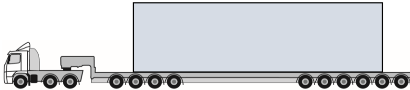
Kuva 3: Tyypillisen tornilohkokuljetuksen havainnekuva (ei mittakaavassa).
