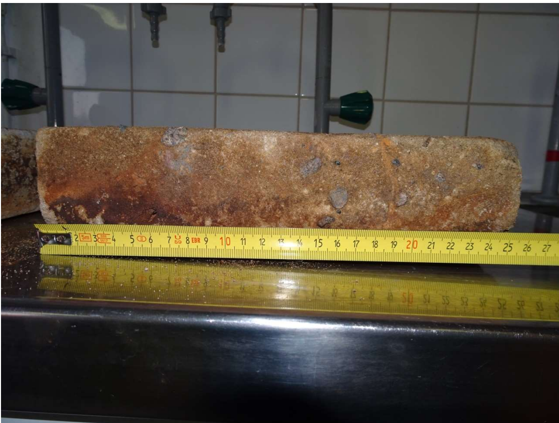
Kuva 67. Hylystä nostettu tiili puhdistettuna, sekoite karkeimmillaan (halkaisija 1,1 cm).
