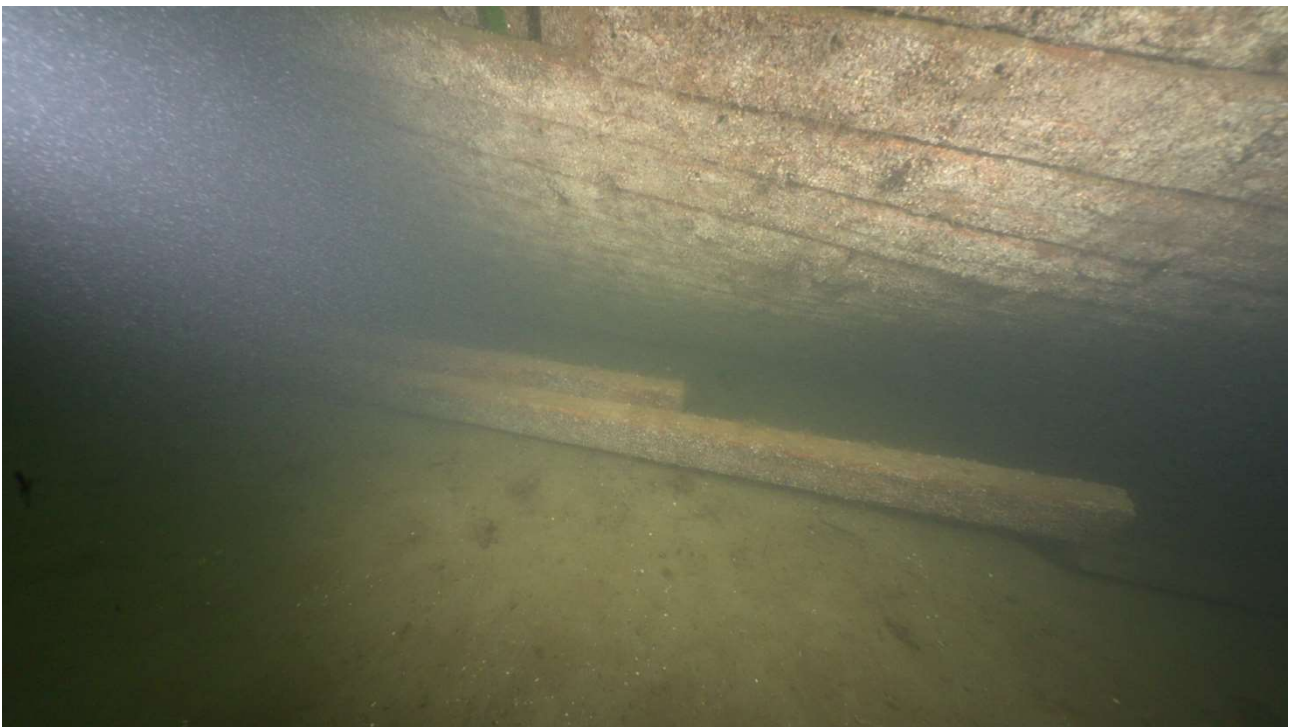
Kuva 4. Styrpuurin puolen kylki keskilaivassa ulkopuolelta katsottuna; kaksiosainen köli on pudonnut hylyn ulkopuolelle.
