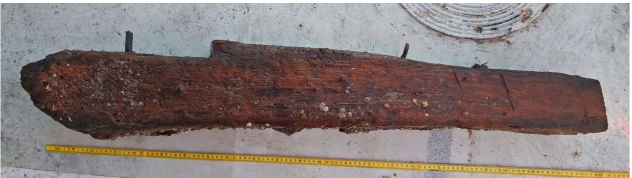
Kuva 44. Dendrokronologinen näyte 1A: V-muotoinen tukirakenne sisäkarneerauksen päällä.
