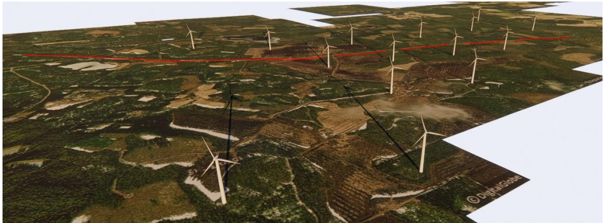
Kuva 3-1. Vaihtoehdon VE1 mukainen layout tuulivoimaloineen (15 kpl) havainnollistettuna 3D-mallina SketchUp Softwaressa. Malli näyttää tuulivoimaloiden sijoittumisen ja korkeudet sekä sähkölínjan sijainnin.
