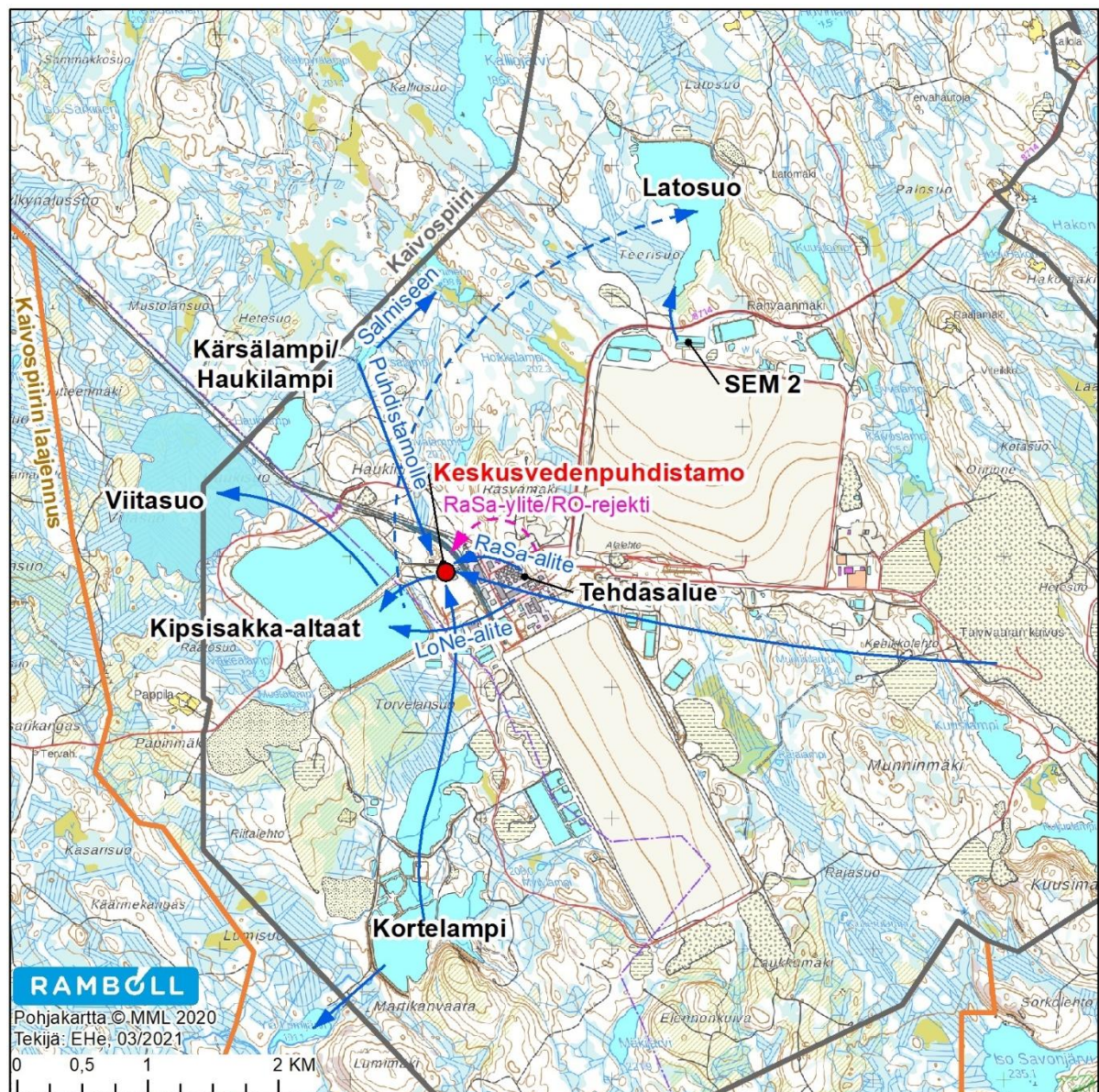
Kuva 33. Kaivosalueella olevien vesienkäsittelyalueiden ja altaiden sijainnit sekä vesien pumppausreitit. Alkuperäinen kuva: Terrafame Oy, vesienhallintasuunnitelma 30.1.2020.
